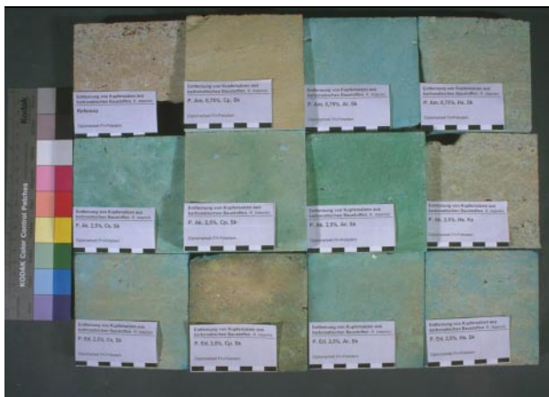
Probepplatten aus Schaumkalk nach zweimaliger Anwendung verschiedener Pasten.
