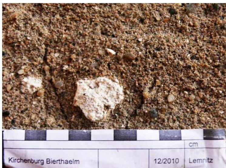
*Stundturm, Bereich Durchfahrt, Kalkputz mit maximaler Korngröße von 3 mm, Kalkspatzen*
