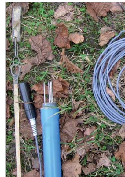
Abb. 4.6 _ Vom Institut für Geotechnik installierte Sonden zur Bodenfeuchtemessung.
