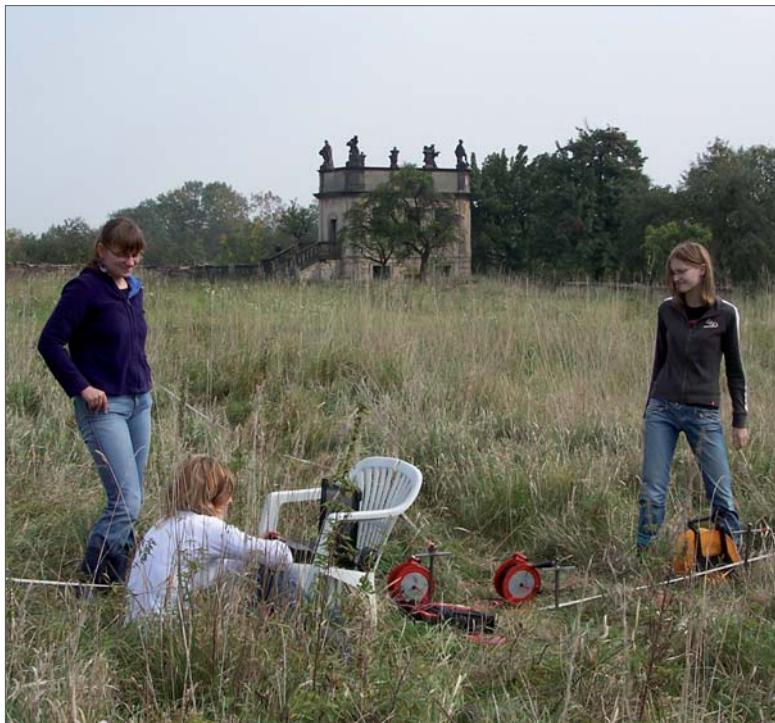
Abb. 4.7 _ Studentinnen der TU Bergakademie Freiberg beim Einrichten der geoelektrischen Messung im Konventgarten.
