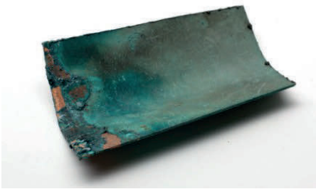
Abb. 13 Grünspan auf einer Kupferplatte, durch Eintauchen in verdünnte Essigsäure und anschließende 6-monatige luftdichte Lagerung gebildet.
