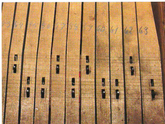
Abb. 6: Versetzung der mittleren Tastenführungen nach vorn.
