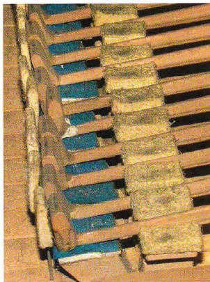
Abb. 7: Buchsbaumholz-Hammerköpfe mit Gebrauchsspuren.
