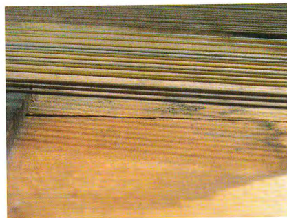
Abb. 11: Riss im Resonanzboden.
