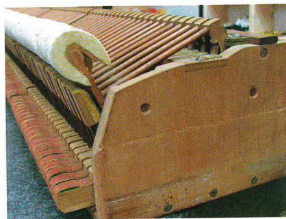
Abb.26: Aufgerissene Hammerkopfbefitzungen mit Holzkern-Bruch.
