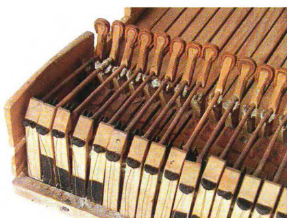
Abb. 14: Defekte Prellzungen, Diskant-Hämmer der Besaitung.
