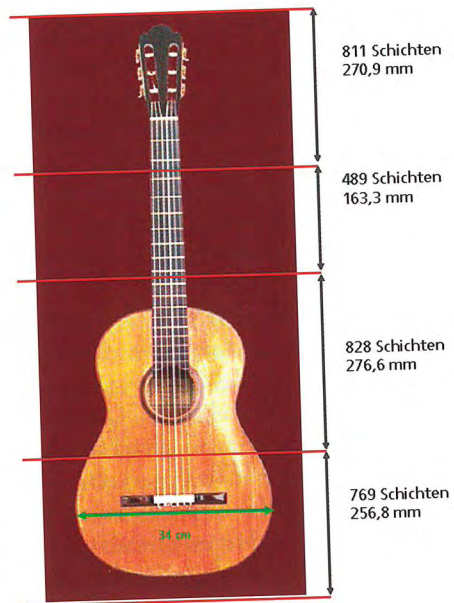
Abb. 3: Die vollständige Messung der Gitarre erfolgte in vier Schritten; die Messzeit, die für jeden der Abschnitte benötigt wurde, lag im Mittel bei 90 Minuten.
