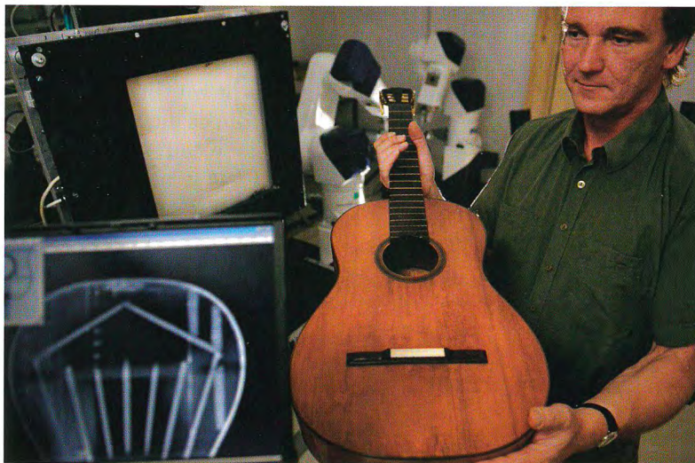
Abb. 2: Im Vordergrund in der Mitte ›La Leona‹, links daneben eines der Durchstrahlungsbilder, welche die Basis für die computertomographische Rekonstruktion des Korpus bilden. Links im Hintergrund eine in der Industrie häufig eingesetzte, flächenartige Röntgenkamera. Rechts: Guido Brennhäuser, der Chef-Anlagentechniker des EZRT in Fürth.
