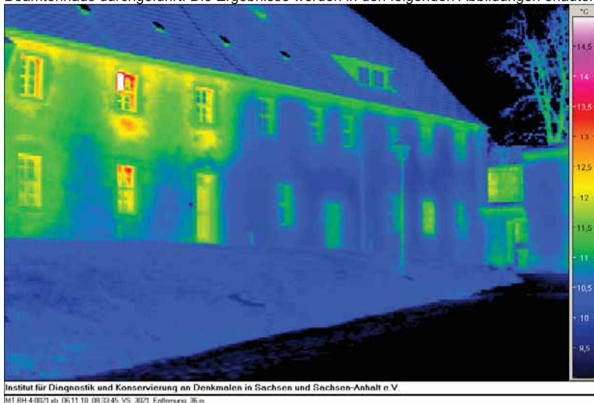
Abb. 74 Südostfassade Haupthaus, rechter, östlicher Teil, zum Untersuchungszeitpunkt keine Nutzung/Beheizung, Abzeichnen der Mauerwerksstrukturen und Fensternischen im bewohnten Teil, ganz links
