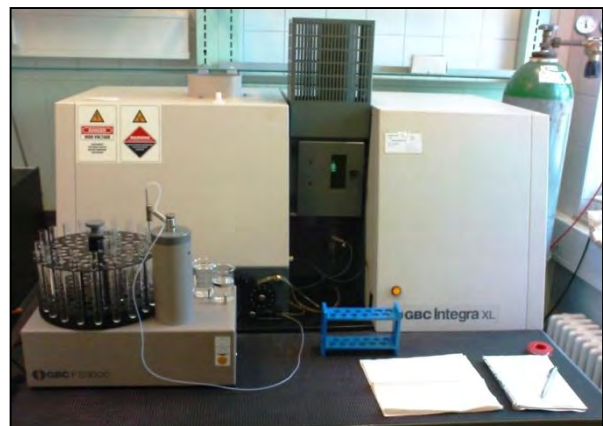
ICP- Analysegerät GBC Integra XL mit Autosampler FS 3000
