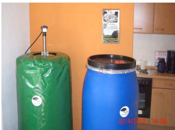
220 L Fermenter und Austauschfass, Zichtau
