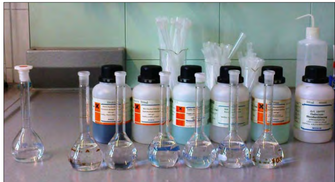
Kalibrierung mittels Standard-Lösungen
