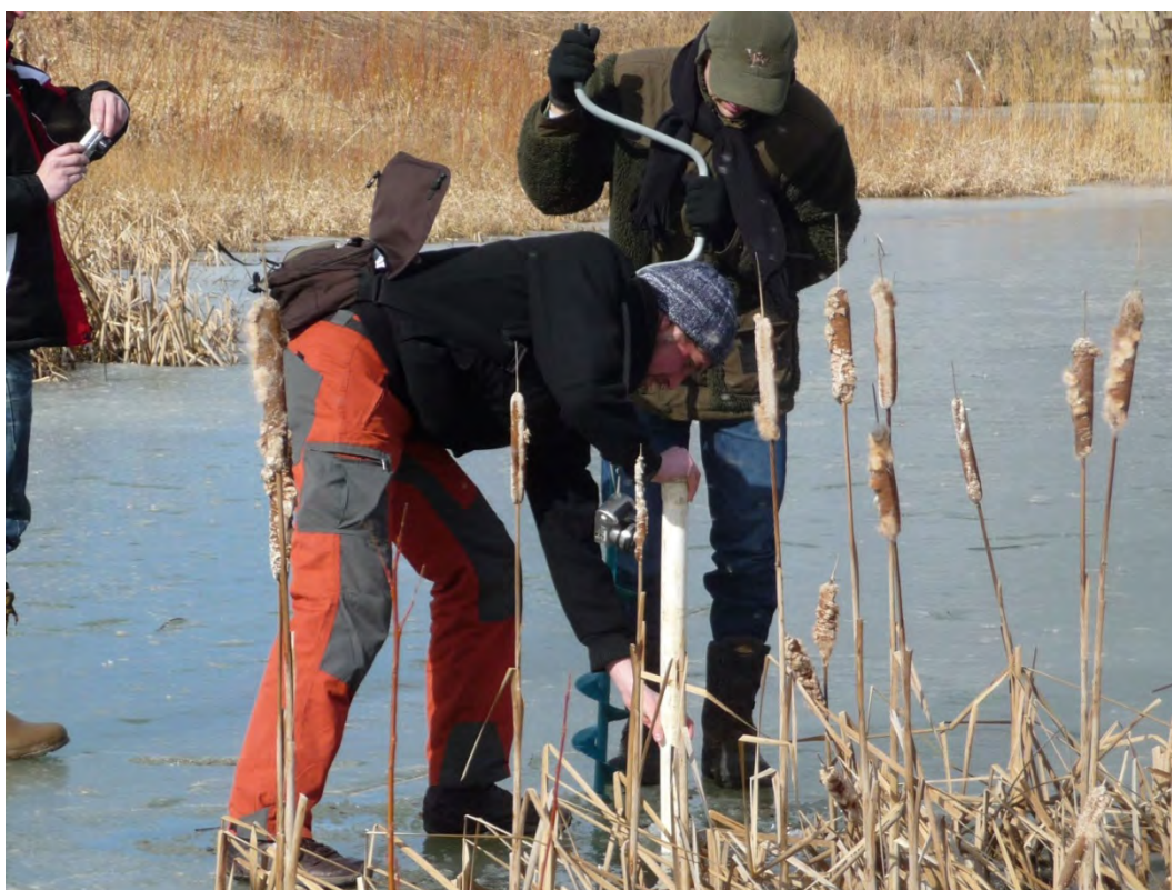
Bohrungen auf dem zugefrorenen Teich zur Probenahme Wasser und Schlamm Nerijus Naruskas, Kay Otto, Martin Schütze (v. l.)
