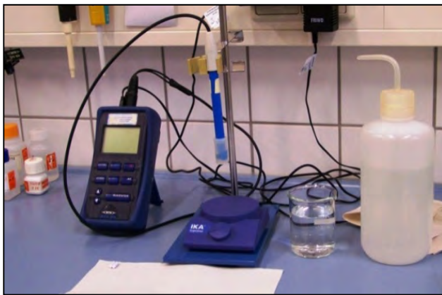
pH-Messgerät mit Magnetrührer
