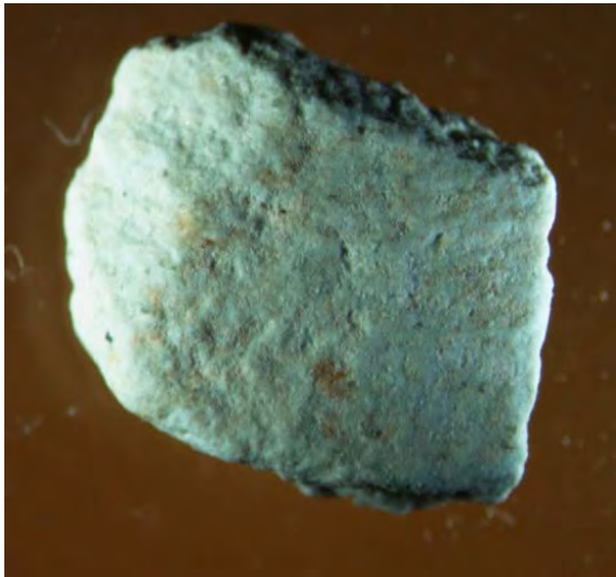
Zeolith-Gestein (trocken) mit erkennbar zerklüfteter Oberflächenstruktur
