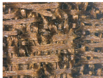
Gewandfragmente Heinrichs IV. Die Mustereffekte werden durch den Wechsel von einem dickeren Schuss und dünneren Schüssen erzielt. Aufnahme am Digital-Mikroskop.
