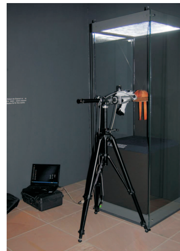
Messung der Elementzusammensetzung mit einem RFA-Handspektrometer. Gemessen werden die Metallfäden, die in die Borten eingearbeitet sind.
