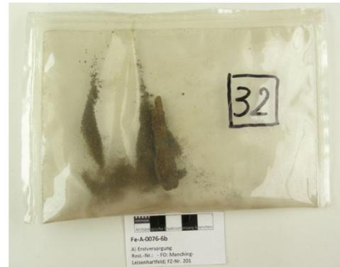
Abb. 10: Objekt in ESCAL™-Folie ohne Zusätze am Ende der Testdauer (Fe-A-0076-6b).
