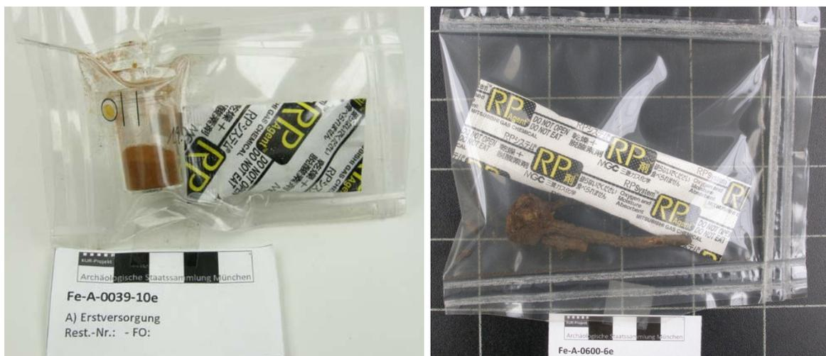
Abb. 17: Pulverindikator in Surlyn™ (Fe-A-0039-10e) bzw. Objekt in ESCAL™-Folie (Fe-A-0600-6e) mit Sauerstoffabsorber.
