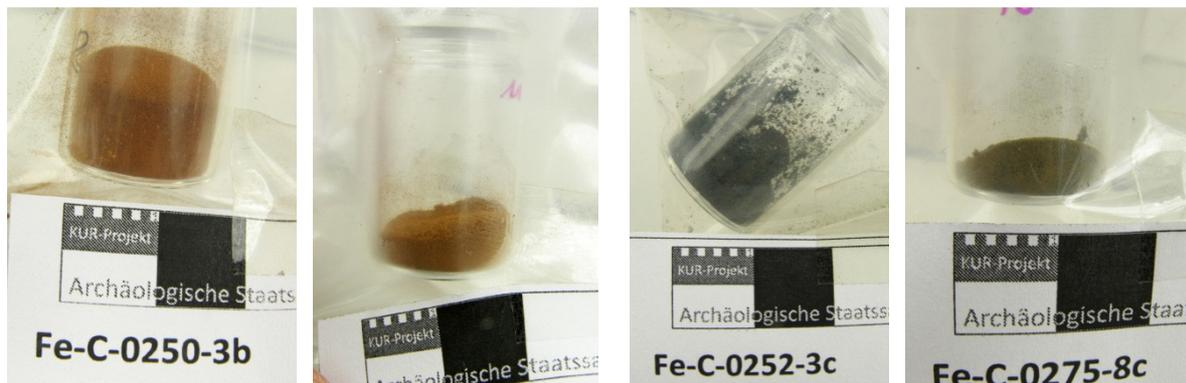
Abb. 27: Gekühlte Pulverproben in PE(100 $\mu$ )- (li.) bzw. ESCAL™-Folie (re.) – das jeweils linke Bild zeigt die bei 4 °C gelagerte Probe, während die rechte bei -35 °C gelagert worden war.
