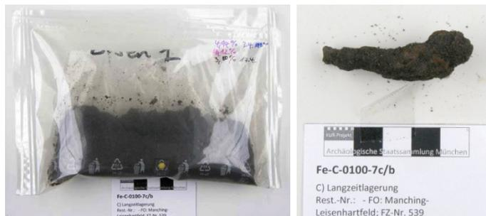
**Abb. 23: Objekt in ESCALTM-Folie mit Erde und Argon (Fe-C-0100-7c/b) nach Ende der Testdauer.**
