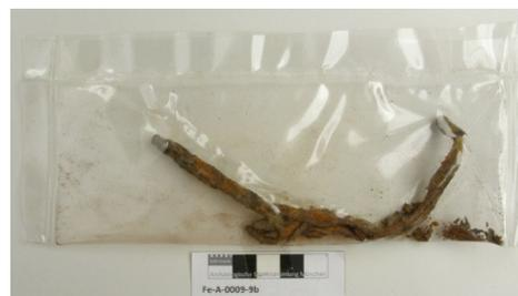
Abb. 9: Objekt in Surlyn™-Folie ohne Zusätze am Ende der Testdauer (Fe-A-0009-9b).
