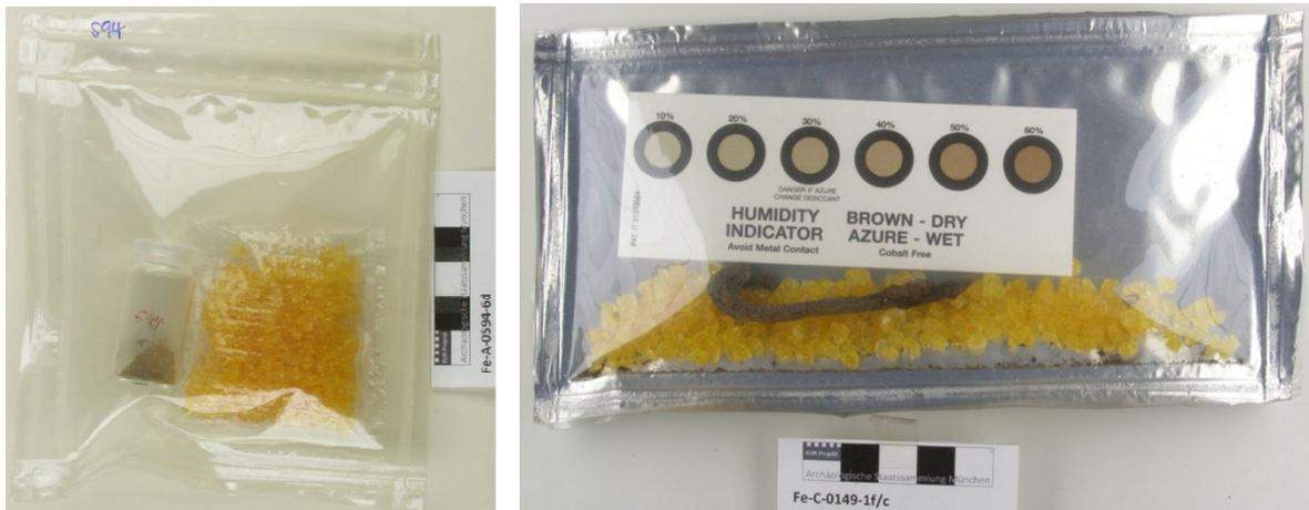
Abb. 21: Pulverindikator in ESCAL™-Folie (Fe-A-0594-6d) und Objekt in Alu-ESCAL™-Beutel (Fe-C-0149-1f/c) mit Silicagel.
