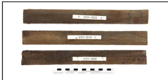
Abb. 57: Versuchskörper von V31 - stark abgebaute Buche (U<sub>max</sub> 887%) - Maße : 33x33x290 mm.
