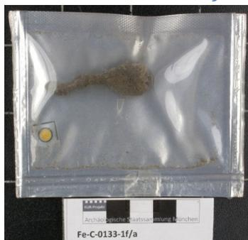
Abb. 10: Objekt in Alu-ESCALM-Beutel ohne Zusätze am Ende der Testdauer (Fe-C-0133-1f/a).
