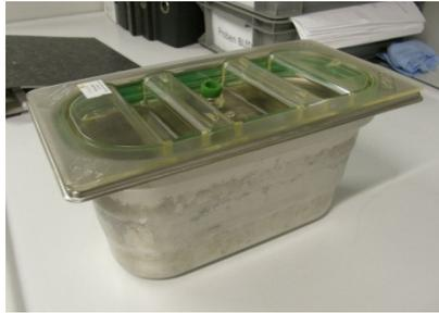
Abb. 30: Vakuumierbarer Gastronormbehälter der Fa. LaVa.
