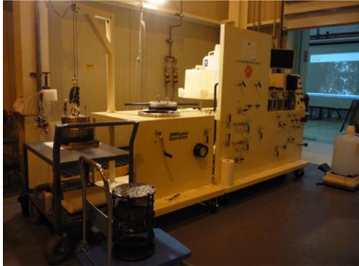
Abb. 31: Subkritischer Entsalzungsreaktor im Clemson Conservation Center.
