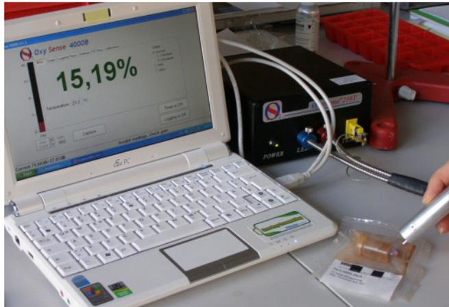
Abb. 5: Das non-invasive Sauerstoffmessgerät.
