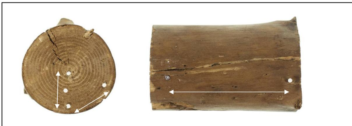
Abb. 47: Radial, tangential und longitudinal ausgerichtete Vermessungsnägel.
