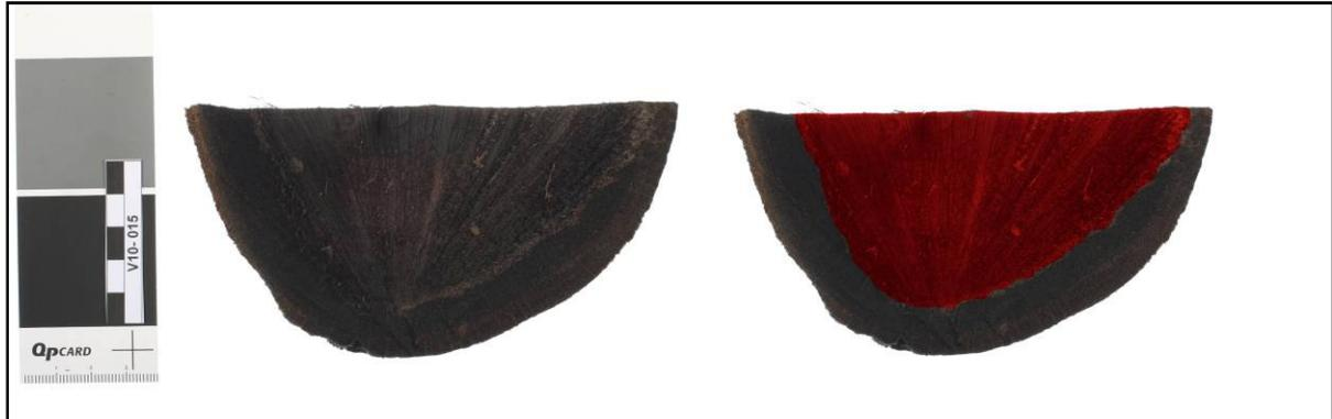
Abb. 43: Rot hervorgehoben ist der gut erhaltene Bereich mit aufgestellten Fasern - Eichepfosten, mittig aufgetrennt.
