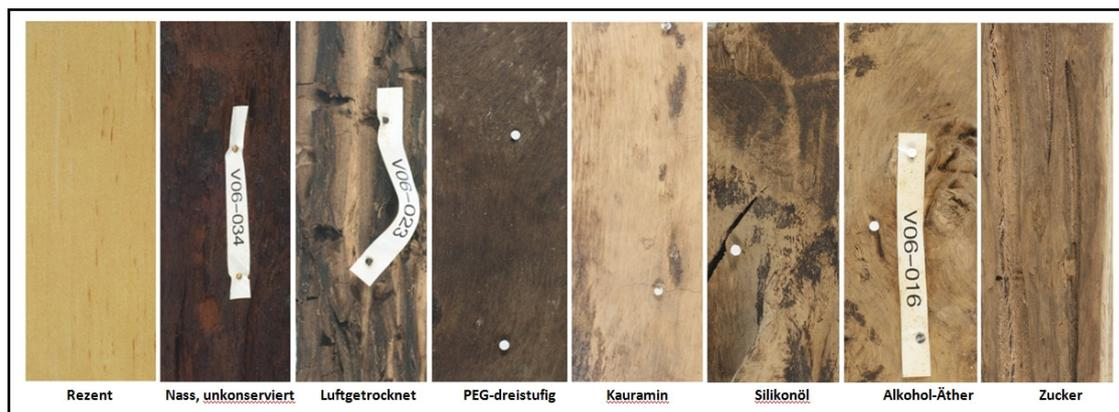
Abb. 55: Versuchsreihe V06 - Stark abgebaute Erle.
