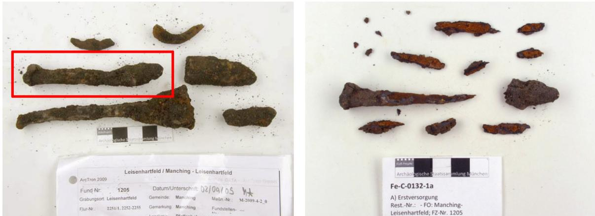
Abb. 7: Ein Nagel aus Manching (Fe-C-0132-1a (5)) kurz nach Eingang in die Werkstatt (rot markiert) und nach 733 Tagen Lagerung bei unkontrolliertem Klima.
