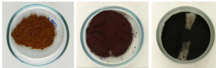
Abb. 38: Akaganeitpulver vor (li.) und nach einer Gasreduktion bei 300 °C (Mitte) bzw. 400 °C (re.).
