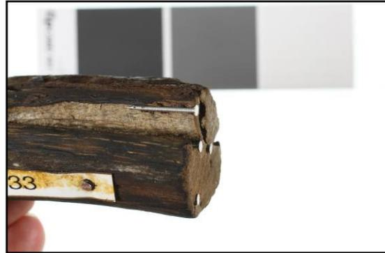
Abb. 49: Gelöster Nagel u. verfälschte Tangentialmessung durch Aufreißen.
