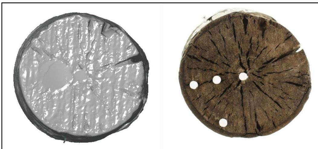
**Abb. 54:** Am Modell sind die feinen Radial-Risse nur ansatzweise zur erkennen - Am Foto des Vorzustandes schon deutlicher.
