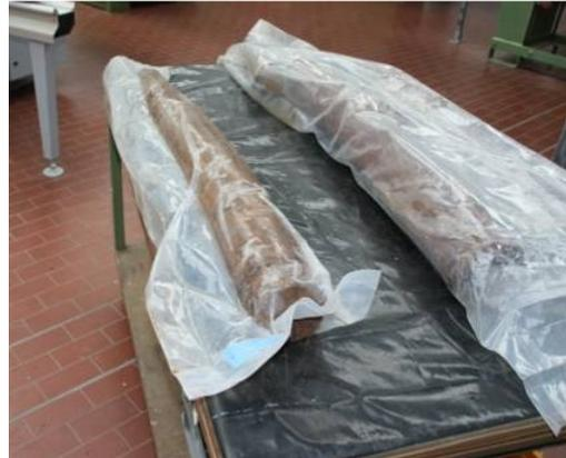
Abb. 41: Lagerung in wassergefüllten Kunststoffbehältern oder Folienverpackung.
