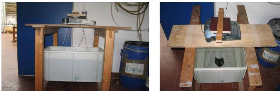
Abb. 58: Einfache Vorrichtung zur Wägung unter Wasser.
