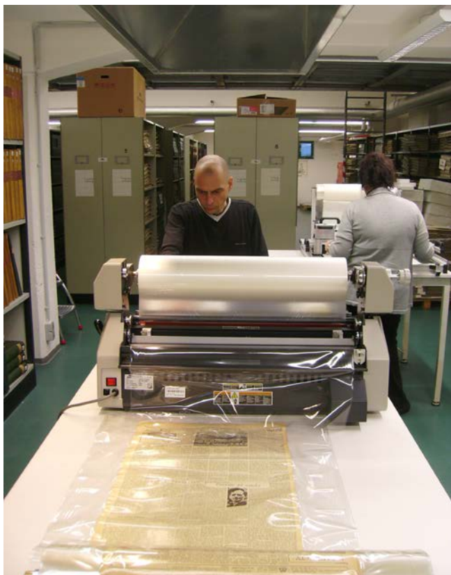
3. Arbeitsschritt: Die fertig laminierten Seiten werden aufgerollt und später passgenau geschnitten (Fotos: Christoph Albers, 16.12.2011)
