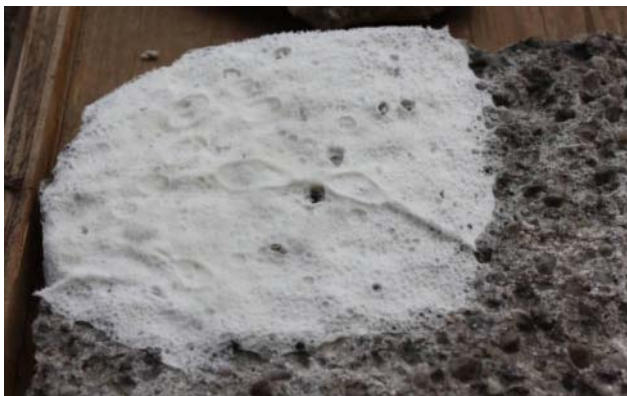
Abb. 417: Scholle 6: abgetrocknetes Hirschhornsalz-Gel
