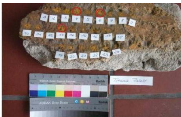
Abb. 384: Putzprobe mit Reinigungsversuchen n. Pietsch
