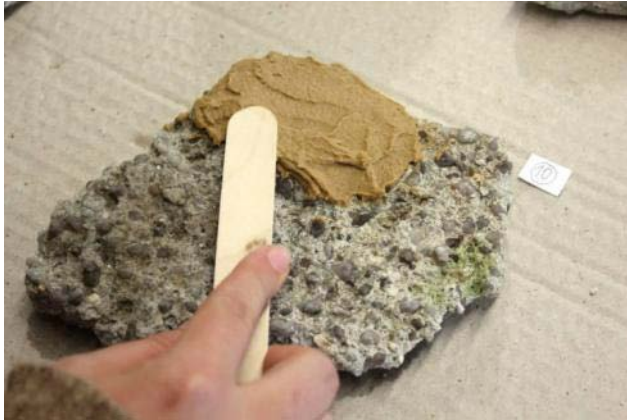
Abb. 426: Scholle 10: Antragen der Ionenaustauscher-Paste
