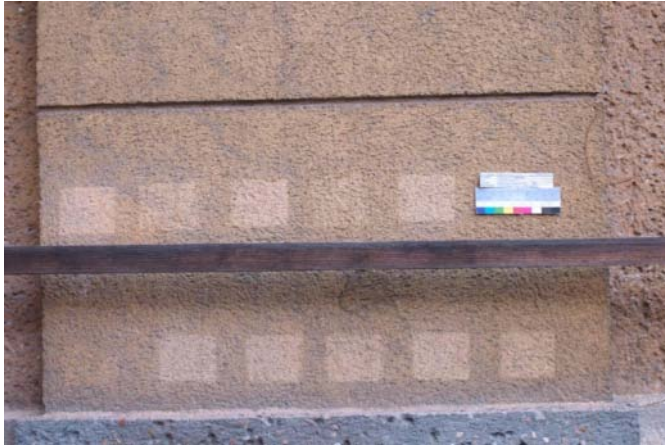
Abb. 406: Reinigungsergebnisse im Vergleich (von links nach rechts)
