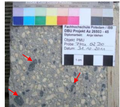
Abb. 528: Pigmentanreicherung, erste Probereihe, PrMi PMU 02 DO.
