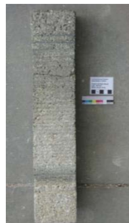
Abb. 381: Nachzustand, Reinigung mit Granat
