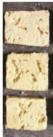
Abb. 457: Ermittlung des Farbtons für den Ergänzungsmörtel; Beprobung auf kleineren Probepplatten; Edelkratzputz Wohnhaus Potsdam und Hufeisensiedlung
