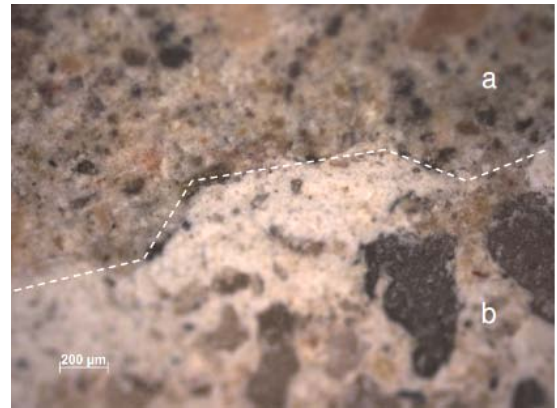
Abb. 269: KuFa 03, mikroskopische Aufnahme Übergang Vorsatzbeton (a) / Kernbeton (b)
