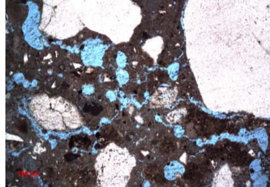
Abb. 267: KuFa Oberputz, Poren- und Risse im Bindemittelgefüge im linearen Licht
