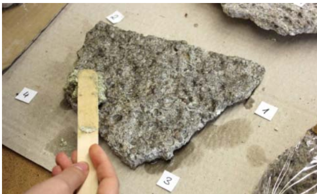
Abb. 421: Scholle 9: Antragen der Hirschhornsalz-Paste
