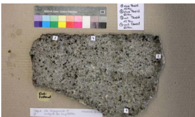
Abb. 419: Scholle 6 erstes Reinigungsergebnis (Hirschhornsalz-Gel)
