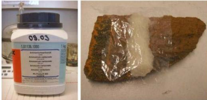
Abb. 386: Ammoniumcarbonat und Komresse mit Folienabdeckung
