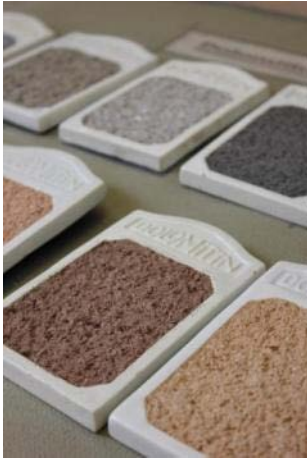
Abb. 1: Historische Putzproben - Tafeln des Herstellers „Dolomitin“ in Kratzputztechnik.
