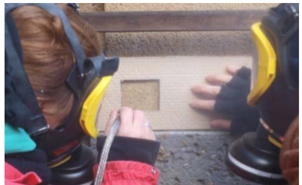
Abb. 403: Anlegen der Testfelder
