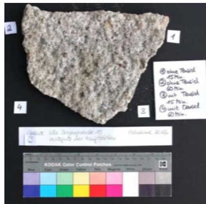
Abb. 424: Scholle 9 erstes Reinigungsergebnis (Hirschhornsalz-Paste)
