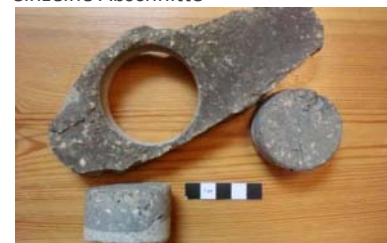
Abb. 547: Bohrkern des bauzeitlichen Steinputzes.
