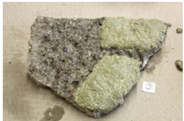
Abb. 422: Scholle 9: angetragene Hirschhornsalz-Paste
