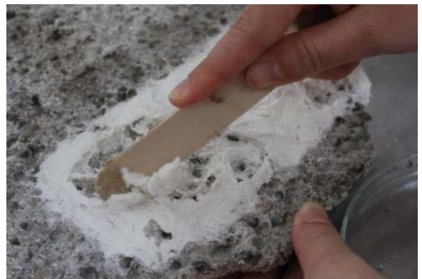
Abb. 418: Scholle 6: Abnahme des Hirschhornsalz-Gels
