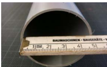
Abb. 542: Rohr für die Herstellung der Probekörper, Ø 5 cm
