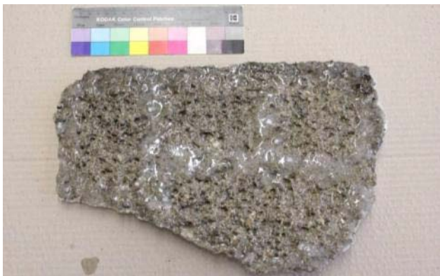
Abb. 415: Scholle 6: angetragenes wässriges-neutrales Gel
