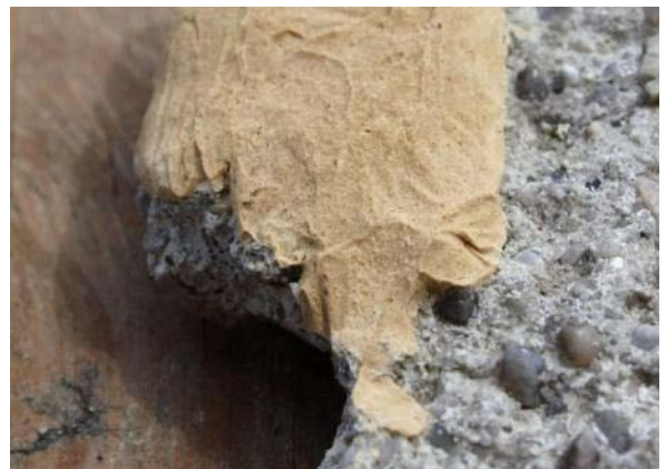
Abb. 429: Scholle 10: durchgetrocknete Ionenaustauscher-Paste
