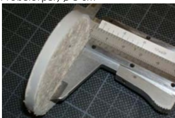
Abb. 545: Kontrolle der Höhe der Probekörper. Höhe = 0,5cm.
