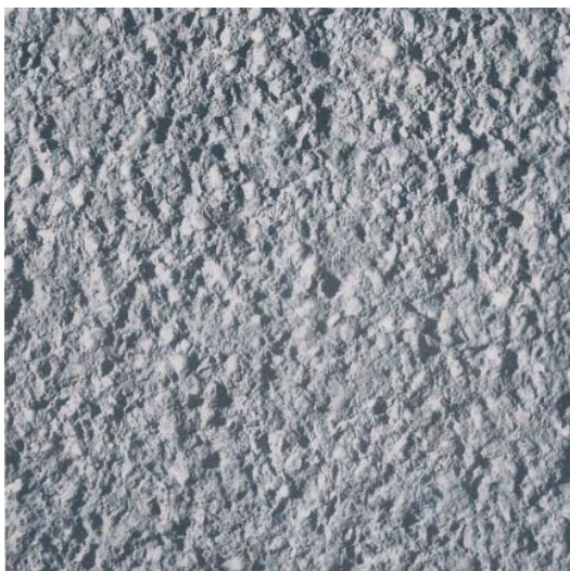
Abb. 68: Terranova - grobkörniger Kratzputz
