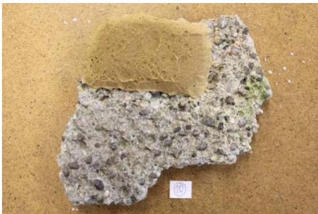
Abb. 428: Scholle 10: halb durchgetrocknete Ionenaustauscher-Paste
