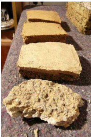
Abb. 457: Ermittlung des Farbtons für den Ergänzungsmörtel; Beprobung auf kleineren Probepplatten; Edelkratzputz Wohnhaus Potsdam und Hufeisensiedlung
