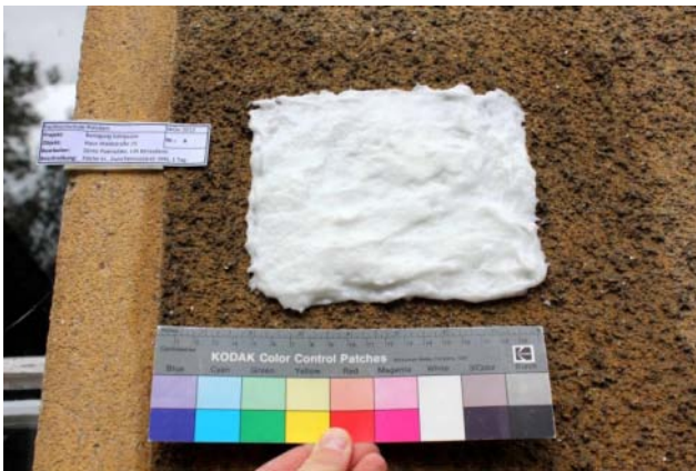
Abb. 438: Hirschhornsalz-Gel auf der Probefläche
