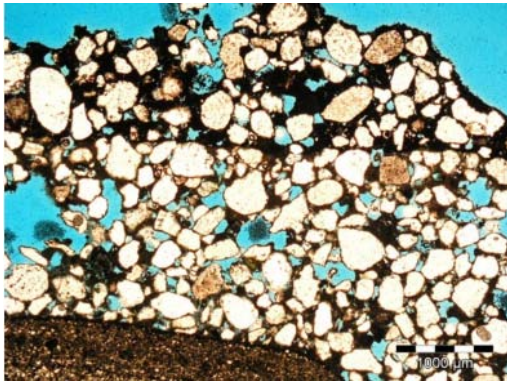
Abb. 202: Huf 03, DS (Ilpol), Gefüge hellroter und dunkelroter (oben) Putz, unten links mehrere cm-großes Sandsteinbruchstück als Zuschlag (Laue)
