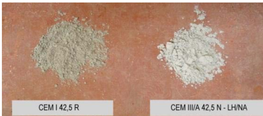
Abb. 520: Portlandzement (links) und Hochofenzement (rechts).
