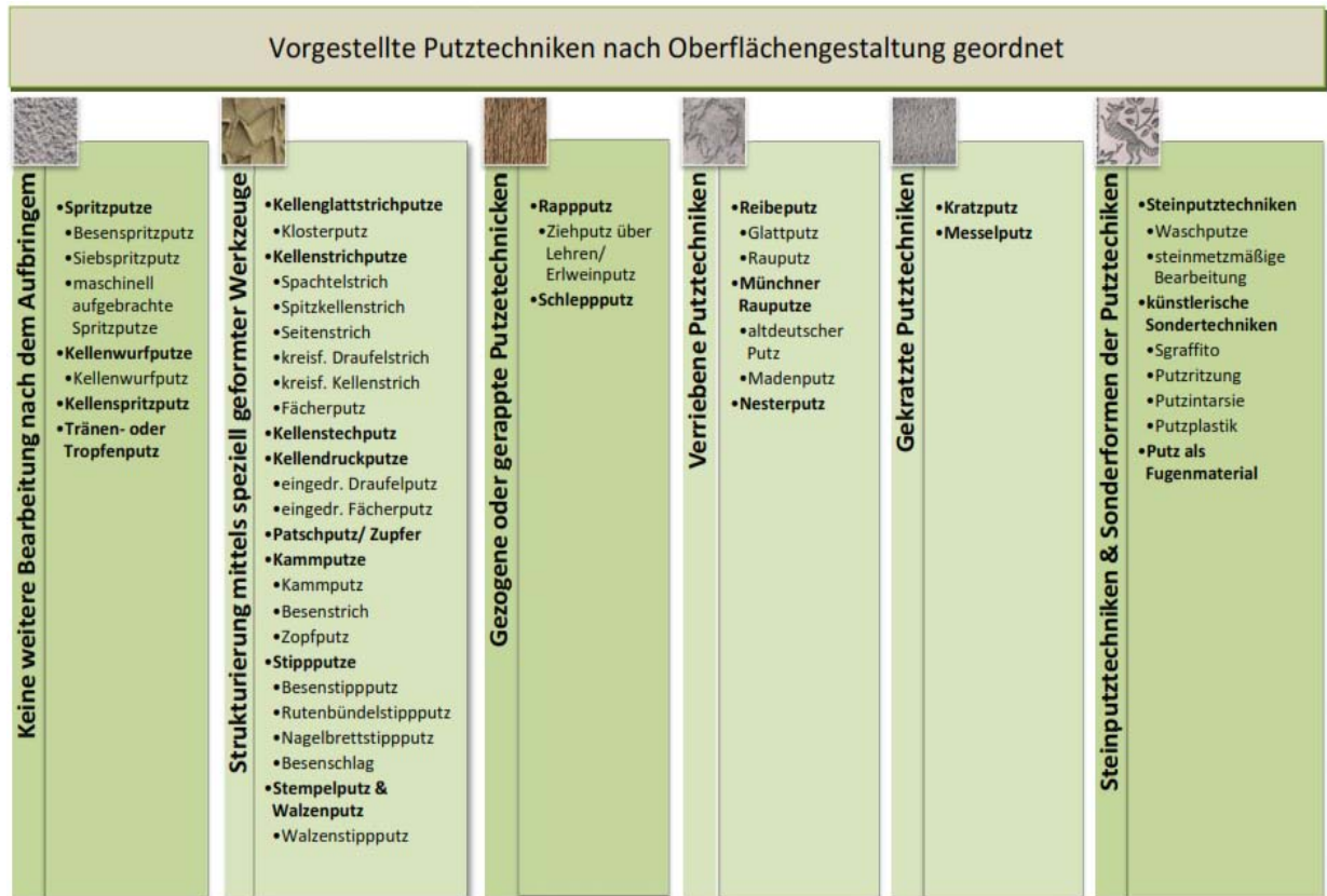
Grafik 1: Putztechniken für die Oberflächengestaltung von Edel- und Steinputzen
