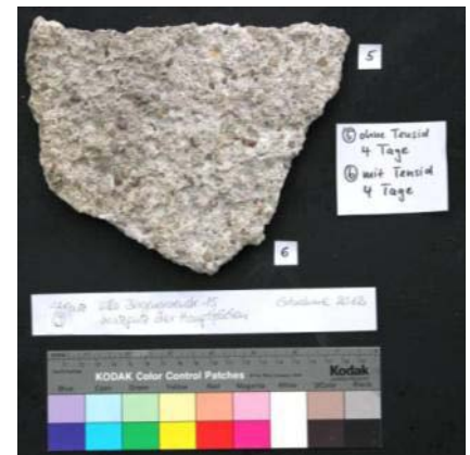
Abb. 425: Scholle 9 Endzustand (Hirschhornsalz-Paste)
