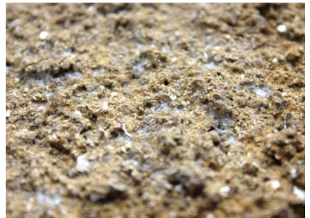
Abb. 439: Hirschhornsalz-Gel –Rückstände auf Probefläche nach Reinigung
