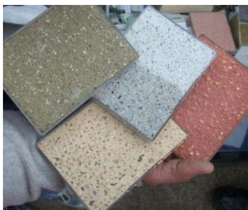
Abb. 152: Steinputzprobenmuster der Firma „Saint-Gobain Weber GmbH“ und die Auswahl für die Probeflächen 2010
