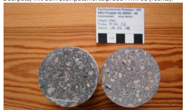
Abb. 556: Bestandsputz (links) und Steinputzmörtelprobe PrMi 02 (rechts)
