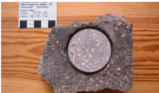
Abb. 563: Vergleich Steinputzmörtelprobe PrMi 06 mit Fragment Bestandputz (bewitterte Oberfläche).
