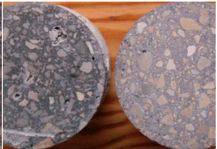
Abb. 568: Bestandsputz (links) und Steinputzmörtelprobe PrMi 04 (Hochofenzement und deshalb Bindemittelanteil etwas heller, rechts)
