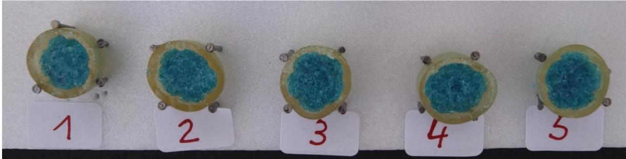
Abb. 63: Probekörper aus Glasmehl, getränkt mit A18.
