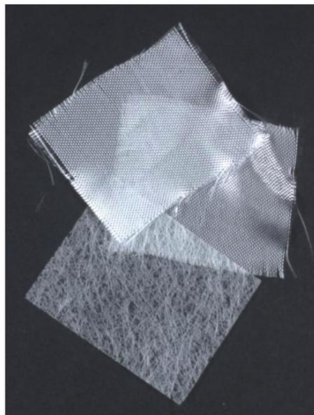
Abb. 65: Glasfasergewebe (die beiden oberen) und Glasfaservlies (unten).
