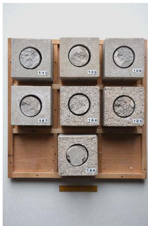
Abb. 110: Probekörper für Haftzugfestigkeit
