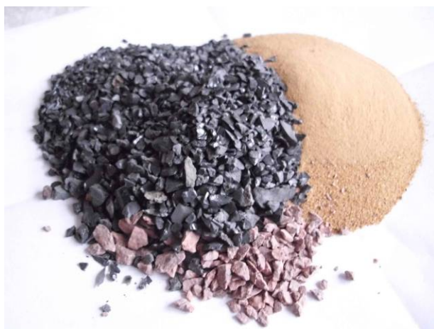
Abb.91: Zuschläge: Mansfelder Kupferschlacke, Porphyrsplitt, Quarzsand
