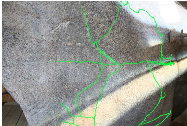
Abb. 63: Datenfusion der 3D-Risskartierung mit einer Photographie des Messbereichs (BBR-Projekt)
