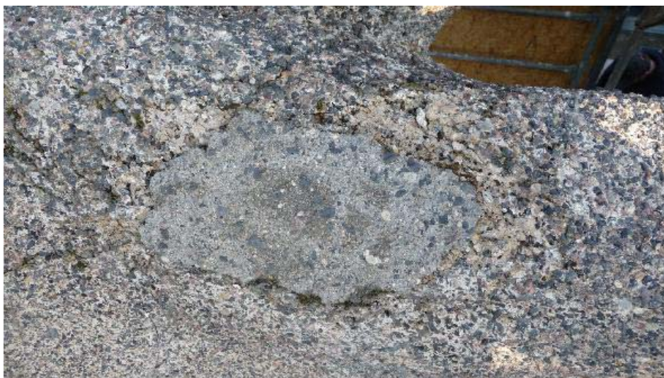
Abb. 129: Eine große Fehlstelle am Hals der Kuh, in der Mitte ist noch die Ergänzung von 1995 zu sehen
