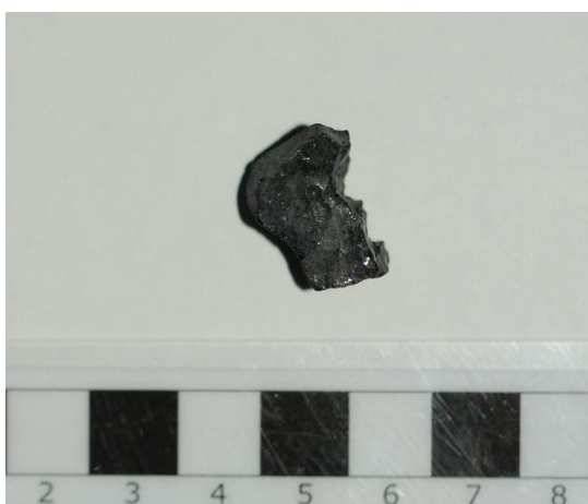
Abb. 93: Mansfelder Kupferschlacke (Glas)
