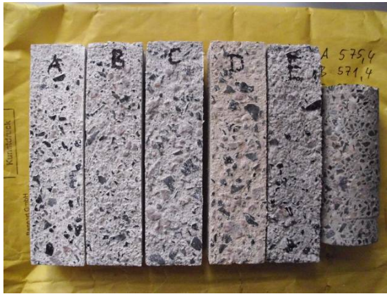
Abb. 96: Probekörper für die E-Modulmessungen und die Untersuchungen zur Wasseraufnahme
