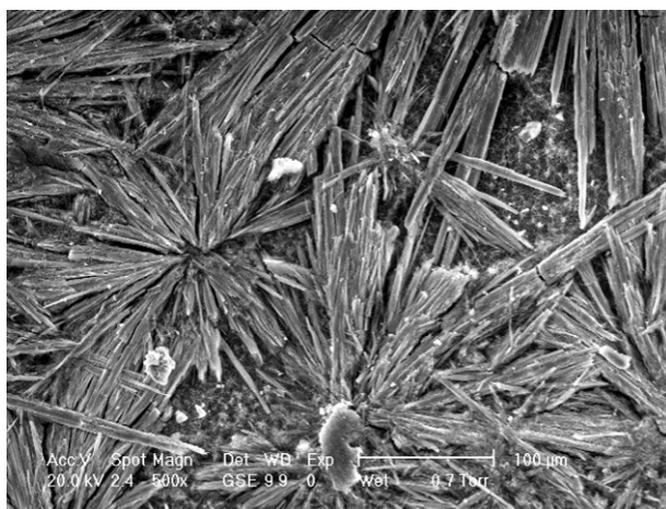
Abb. 52: Ettringit, REM-Aufnahme aus WEISE & HEMPEL, 2006
