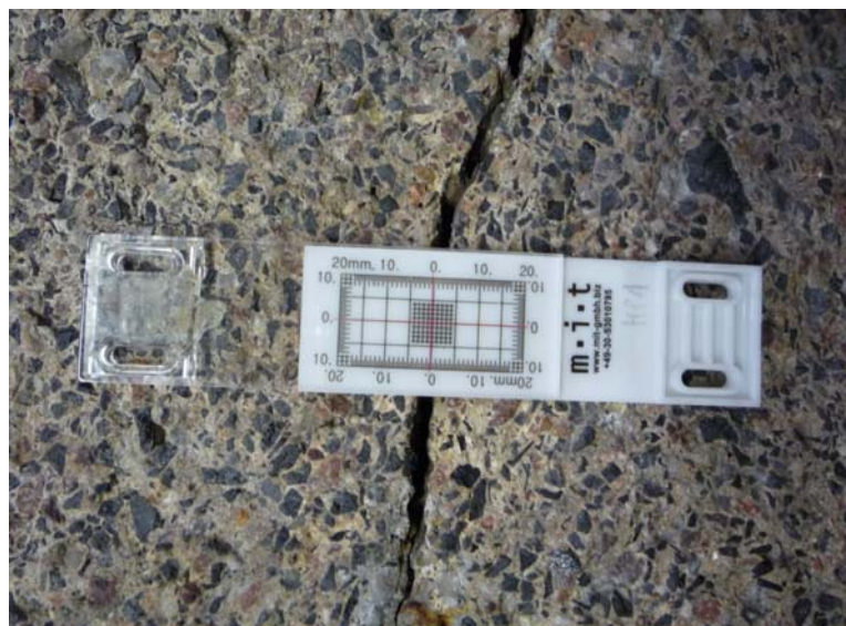
Abb. 33: Im Projekt verwendeter Rissmonitor
