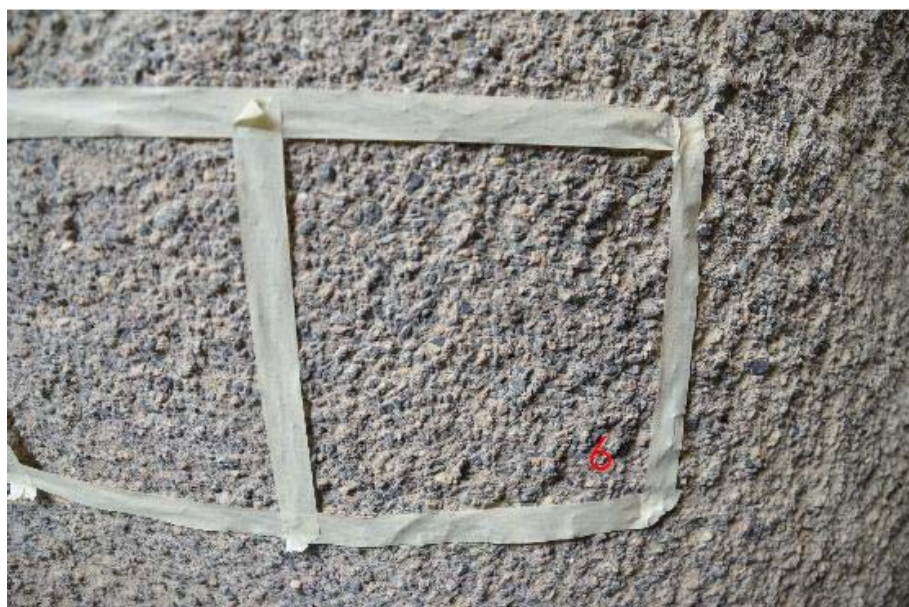
Abb. 144: Schlammprobe 6 von Abb. 142; diese unpigmentierte Schlämme wurde als Überzug für die gesamte Kuh favorisiert
