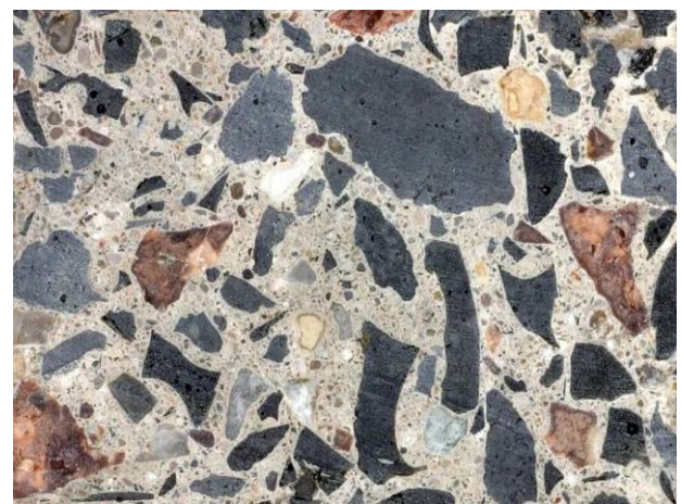
Abb. 92: Stamfbetongefüge, Anschliff, untere Bildkante entspricht 4 cm
