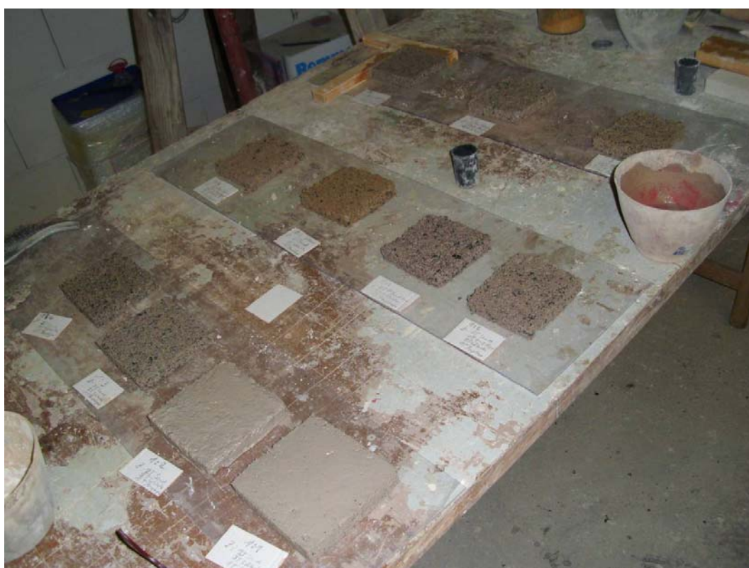
Abb. 88: Herstellung von Ergänzungsmörtel-Materialproben unterschiedlicher Farbigkeit und Zusammensetzung für die Bemusterung durch den Restaurator Herrn Reichenbach
