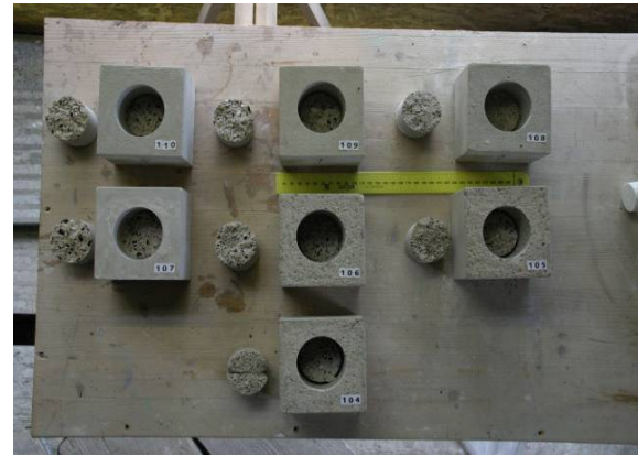
Abb. 97: Zweisteinproben, Probekörper für die Haftzuguntersuchungen
