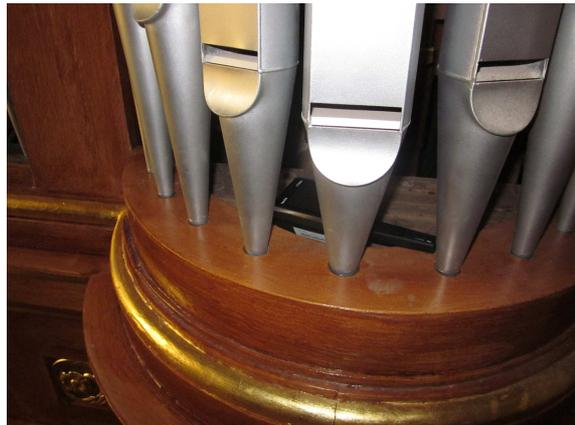
Das IDK überwacht das Raumklima auch selbst, sodass eine größtmögliche Sicherheit besteht, Fehlfunktionen schnell zu erkennen und gegenzusteuern. Darüber hinaus ermöglicht es eine Optimierung des Raumklimas.
