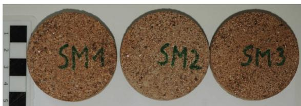
Abb. 23 Zweisteinproben für Haftzugmessungen mit mineralischer Fuge, Aufsicht
