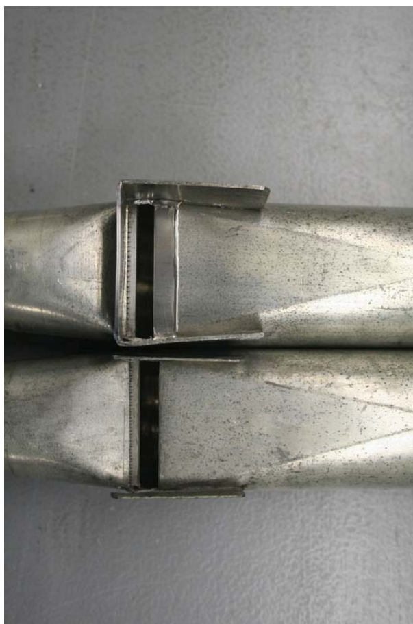
Abb. 64 Oben Durch Ergänzung rekonstruierter Kastenbart H Fugara 8' und unten c° mit originalen Seitenbärten
