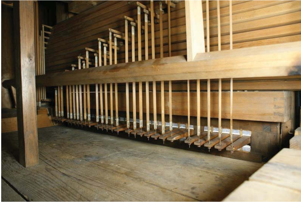
Abb. 31 Anbindung Pedaltasten and die Tontraktur nach der Restaurierung
