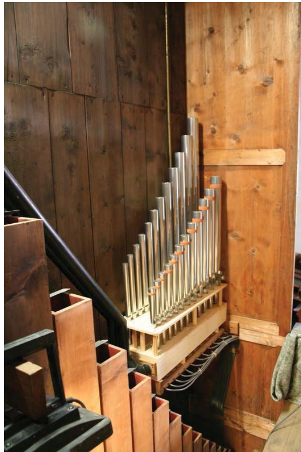
Abb. 25 Rekonstruierte pneumatische Zusatzlade D-Seite
