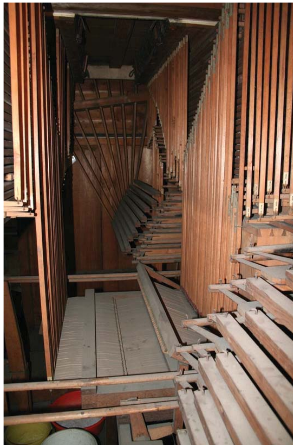
Abb. 28 Blick in die Tontraktur vor der Restaurierung
