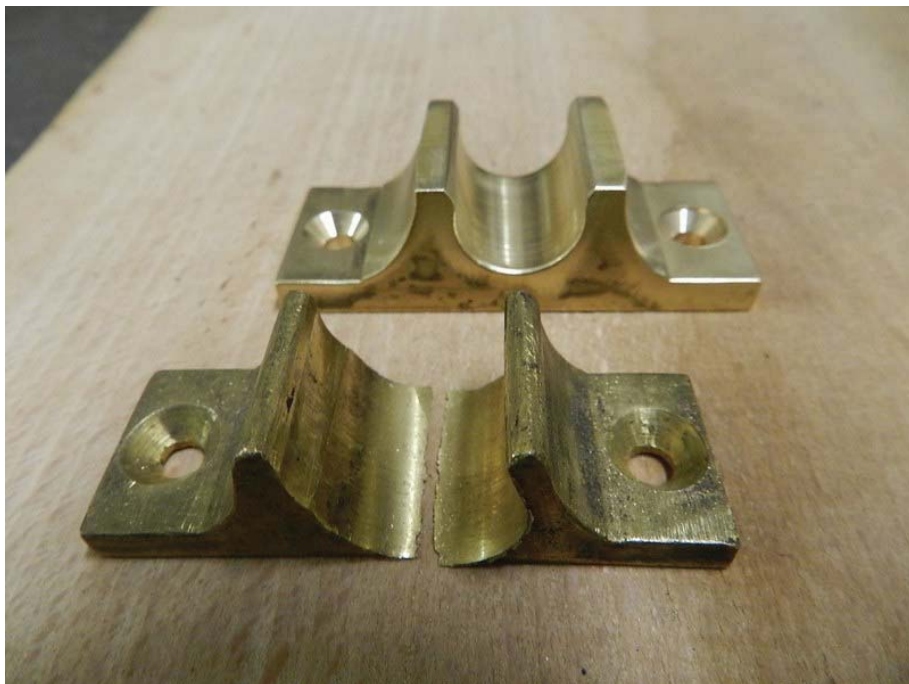
Abb. 44 Lagerschale für Seilzugrolle in ausgearbeitetem Zustand und rekonstruiert
