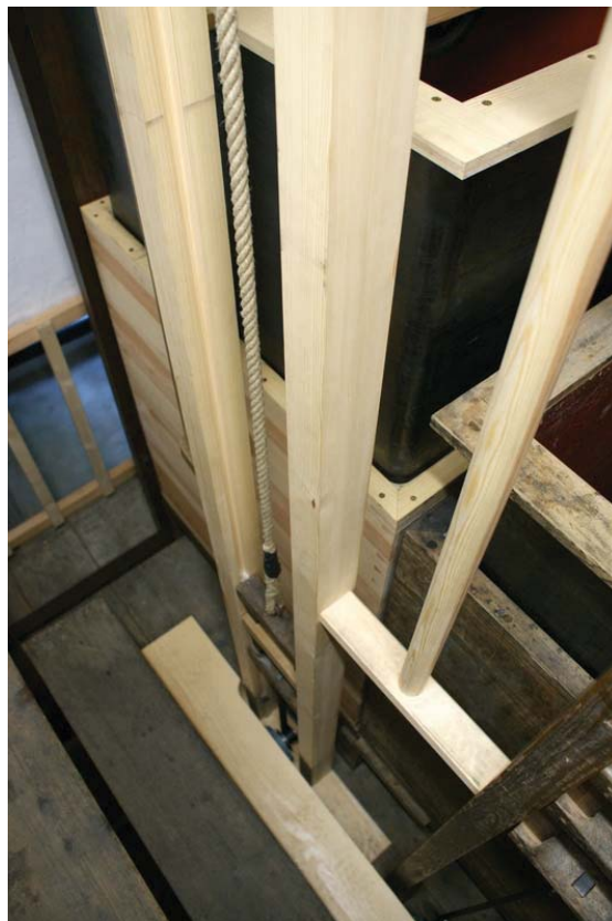
Abb. 49 Rekonstruierter Kastenbalg in aufgezogenem Zustand
