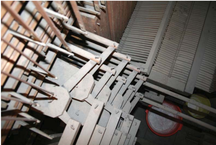
Abb. 35 Registermechanikwinkel vor der Restaurierung
