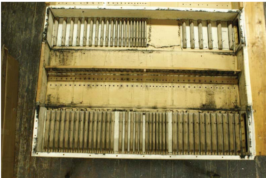
Abb. 11 Geöffnete Windlade mit abgenommener Abdeckleiste
