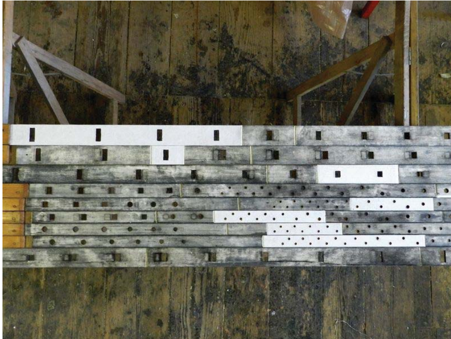
Abb. 19 Partiell erneuerte Schleifenbelederungen
