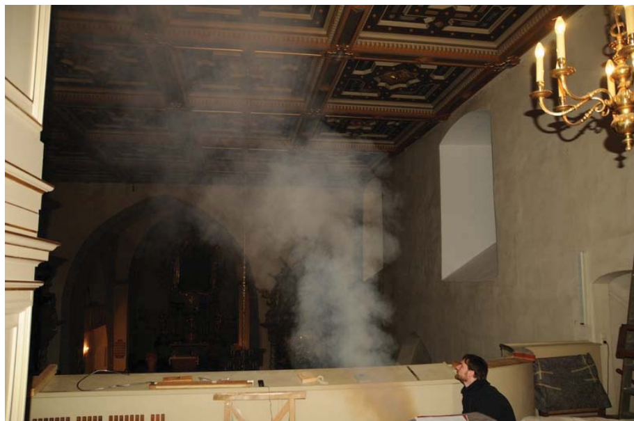
Abb. 1 Pfarrkirche „Mariä Himmelfahrt, Ostritz Visualisierung der vorherrschenden Luftströmungen durch einen Nebelversuch
