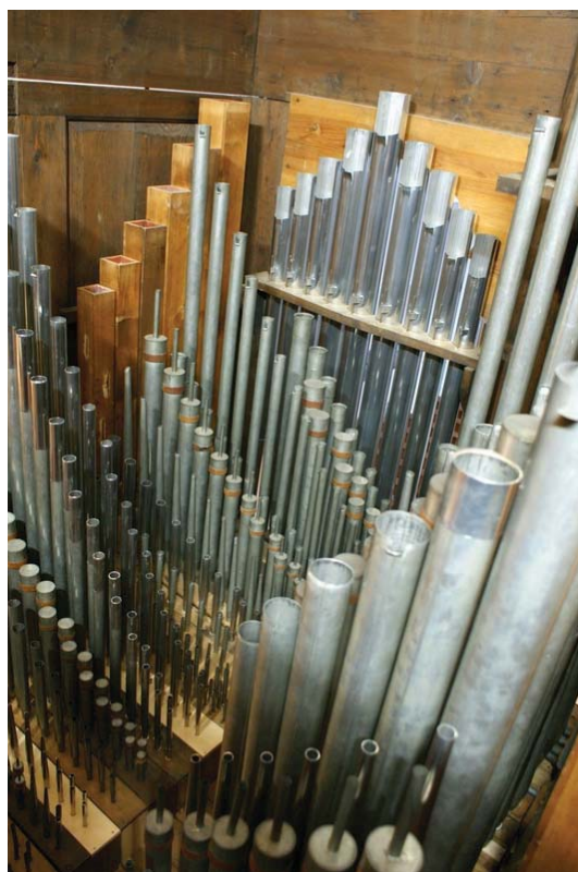
Abb. 56 Blick auf das Pfeifenwerk D-Seite nach der Restaurierung mit Ansicht Rückseite der rekonstruierten Prospekt Pfeifen
