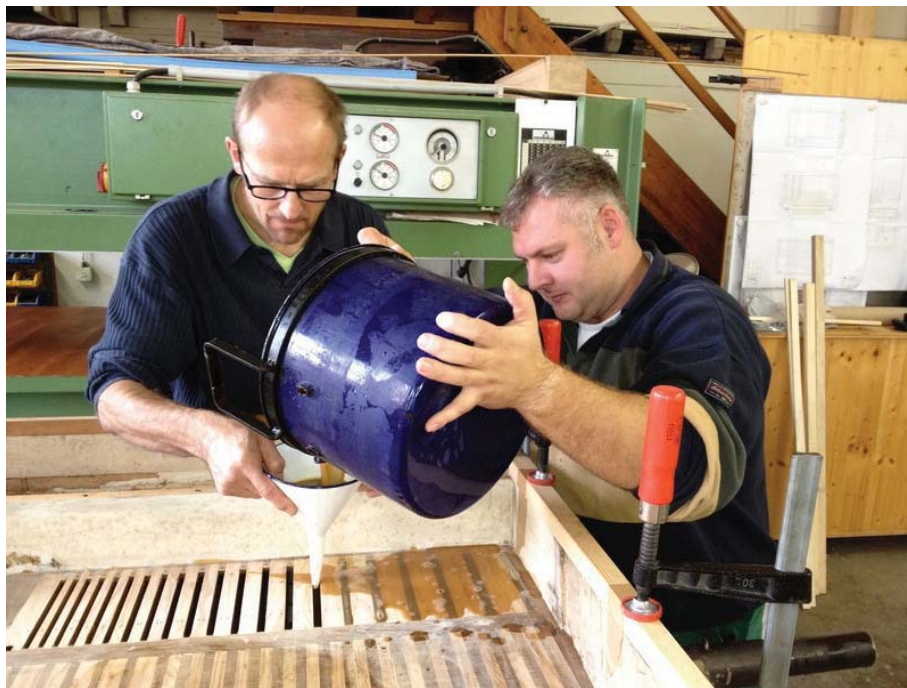
Abb. 21 Ausgießen von Kanzellen mit Warmleim
