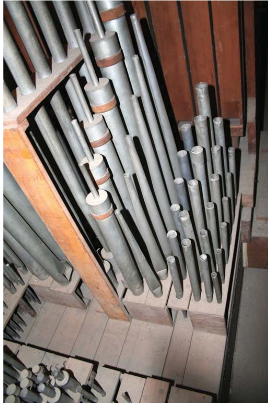
Abb. 53 Blick auf das Pfeifenwerk des II. Manuals im vorgefundenen Zustand mit Dulcian 8'
