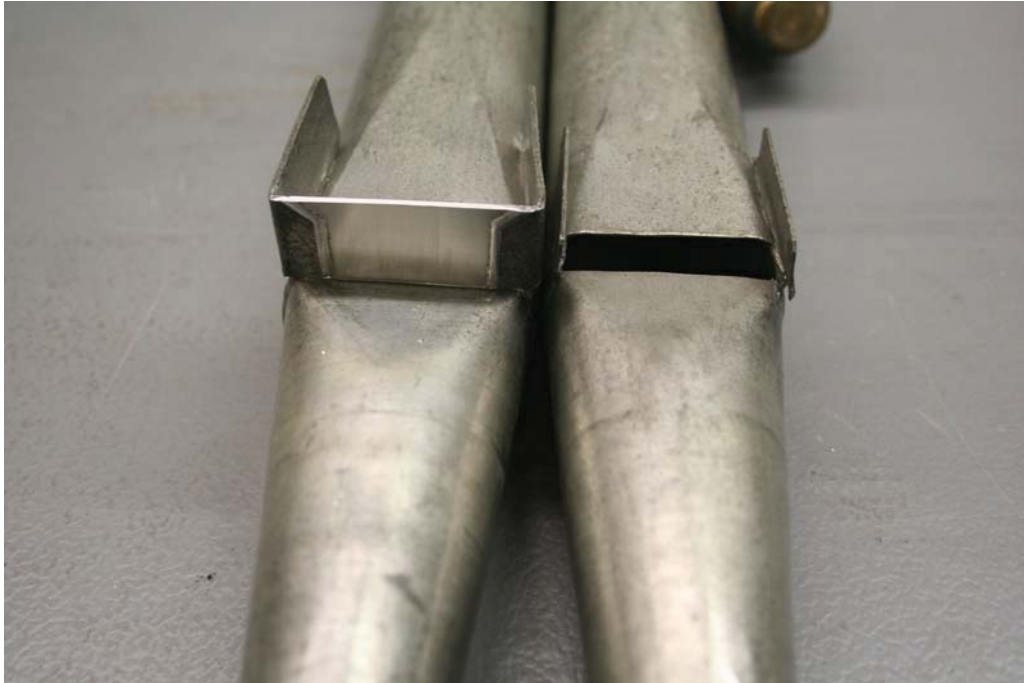
Abb. 65 Untersicht rekonstruierter Kastenbart H Fugara 8' und c° mit originalen Seitenbärten
