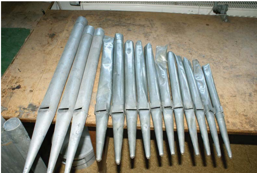
Abb. 58 Zum Originalbestand zugehörige Flöte 8' Pfeifen in vorgefundenem, eingekürzten Zustand sowie drei davor gesetzte Fremd Pfeifen
