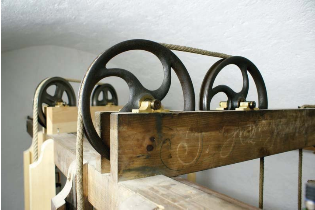
Abb. 45 Seilzugrollen mit erneuerten Lagerschalen
