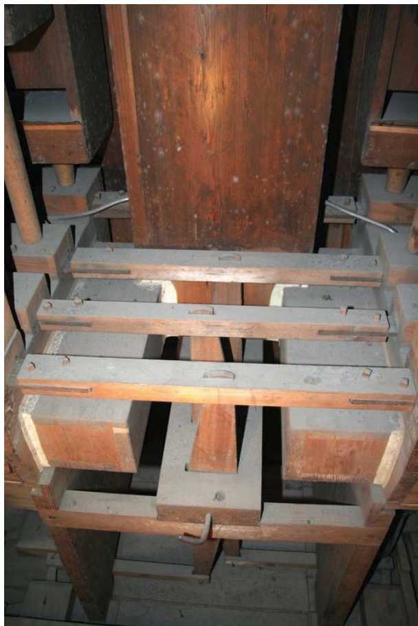
Abb. 37 Registerschwerter mit Schleifenverbindern Pedal vor der Restaurierung
