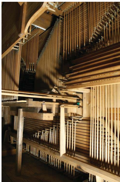
Abb. 34 Überblicksansicht der Tontraktur nach der Restaurierung
