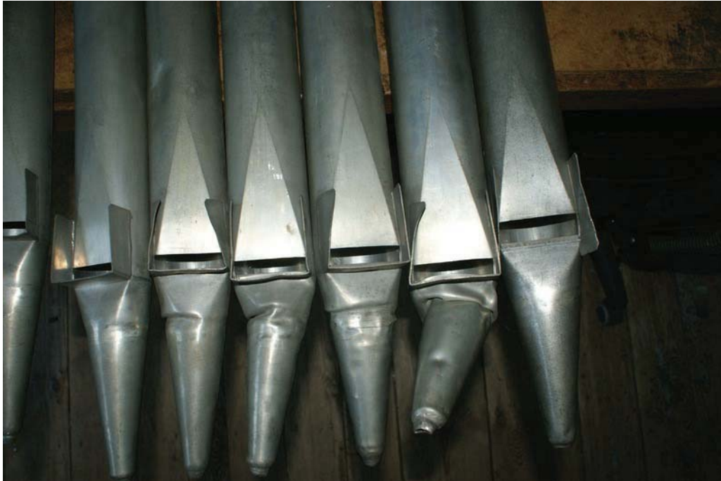
Abb. 59 Flöte 8' Pfeifen in vorgefundenem Zustand, rechts außen eine Fugara Pfeife
