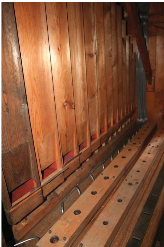
Abb. 27 Bleikondenken eingelassen in Tonkzellen der Pedalwindlade D-Seite
