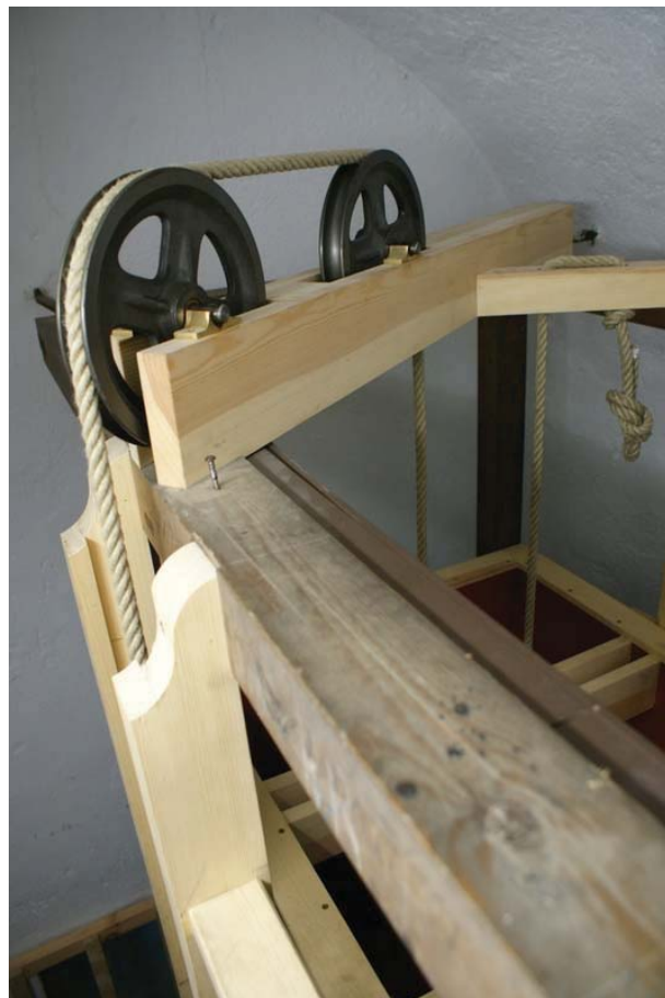
Abb. 46 Ergänzte Seilzugrollen für rekonstruierten Kastenbalg
