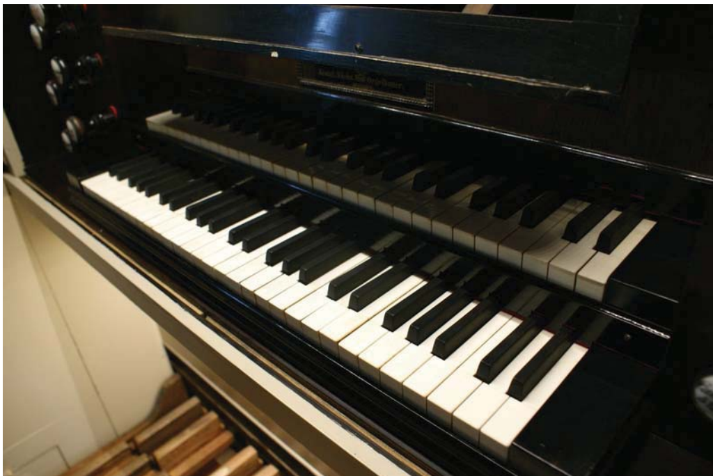
Abb. 8 Restaurierte Manualklavatur mit partiell erneuerten Tastenbelägen
