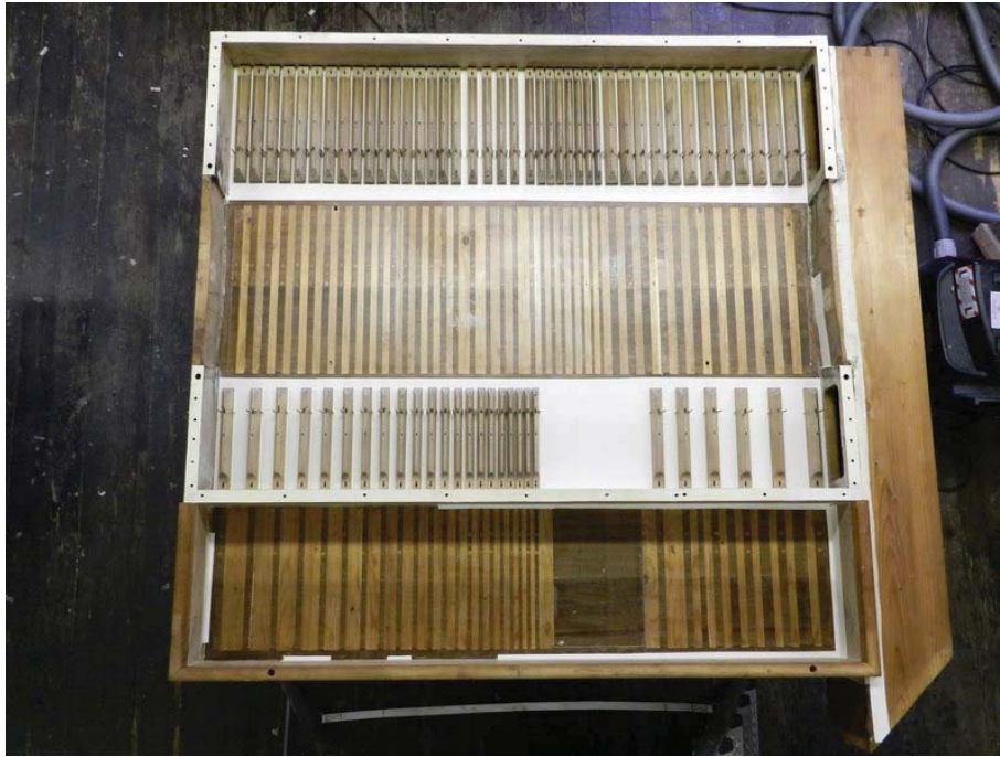
Abb. 22 Unterseite Manuwindlade mit erneuerter Papierung im Ventilaufgabebereich, Pergamentierung der Bereiche außerhalb der Windkästen
