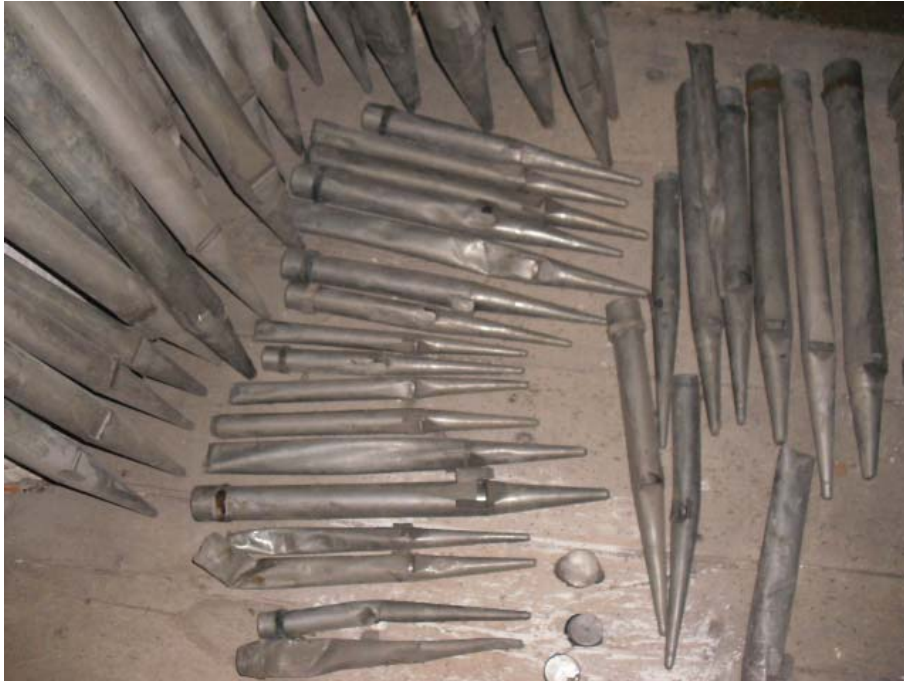
Abb. 57 Mischbestand Pfeifenfund ehemalige Besetzung pneumatischer Zusatzladen
