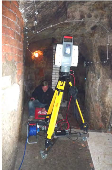
Abbildung 4: 3D Laser Scanstation im Rappenkeller (Photo Frank Bier).
