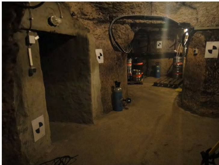
Abbildung 7: Positionierte Black/White- und HDS-Messmarken im vorderen Kellerbereich, Blickrichtung nach Norden.
