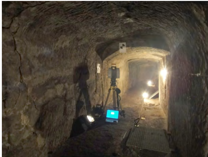
Abbildung 5: 3D Laserscanner im Rappenkeller. Photo Frank Bier.
