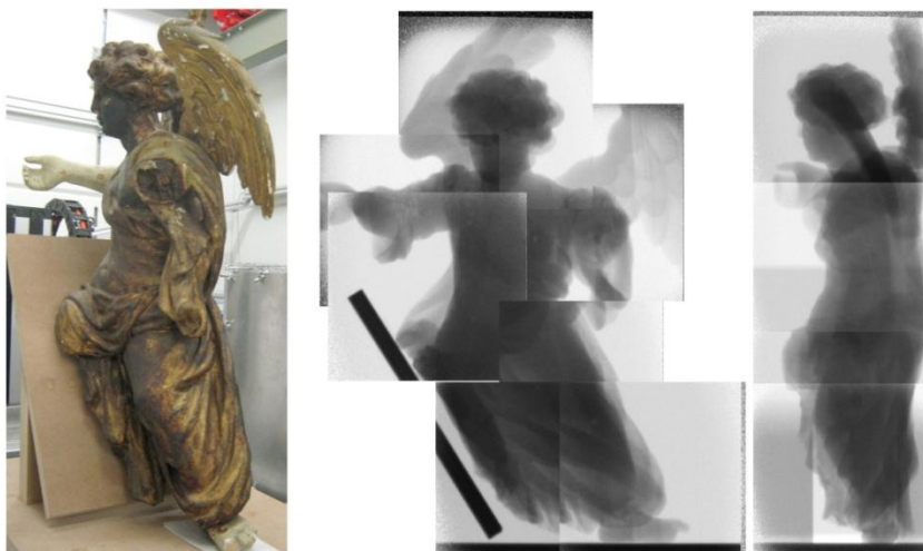
Abb. 18: Durchstrahlung der Engelsfigur mit Neutronen.
