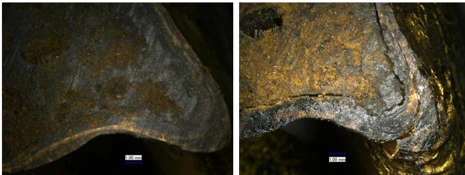
Abb. 62: Holzschnittfläche vor (links) und nach (rechts) der Dekontaminierung mit 1,3-Dioxolan.
