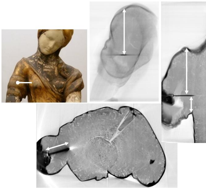
Abb. 33: Lage und Länge des Nagels im Arm der Assistenzfigur in CT-Schnittschichten.
