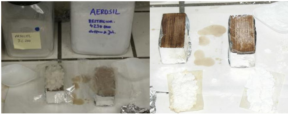
Abb. 80: Das Kompressenmaterial in Folie gewickelt (links) sowie Mock-ups nach Abnahme des jeweiligen Kompressenmaterials (rechts).
