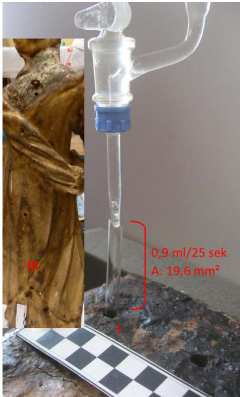
Abb. 58: Versuchsaufbau zur Lösungsmittelpenetration über der Grundfläche quer bzw. längs zur Faserrichtung (III bzw. I).
