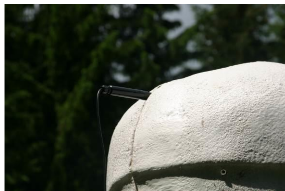
Abb. 123 Messung des Luftwechsels durch CO 2 -Abnahme an ciccum®
