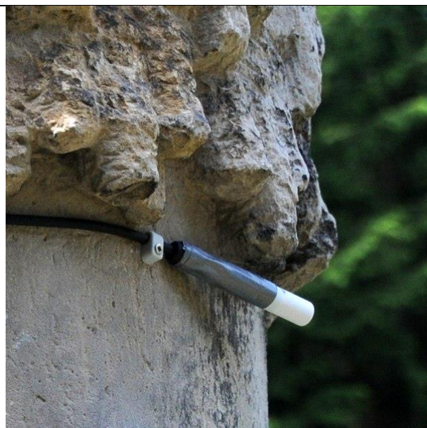
Abb. 114 Digitaler Fühler für Luftfeuchte und Temperatur (Fühler wassergeschützt)
