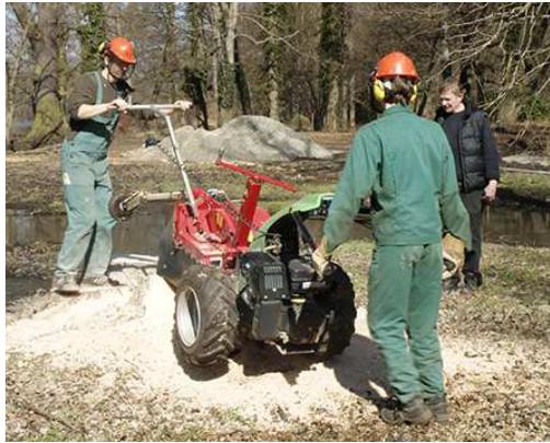
Foto 6: Stubbenfräse im Einsatz
