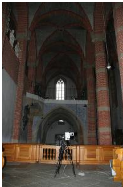
Abb. 79 IR-Untersuchungen im Kirchenschiff
