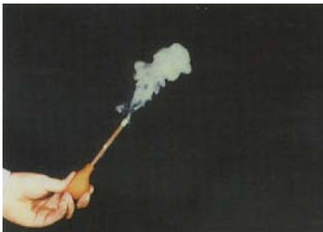
Abb. 71 Strömungsprüfröhrchen im Einsatz
