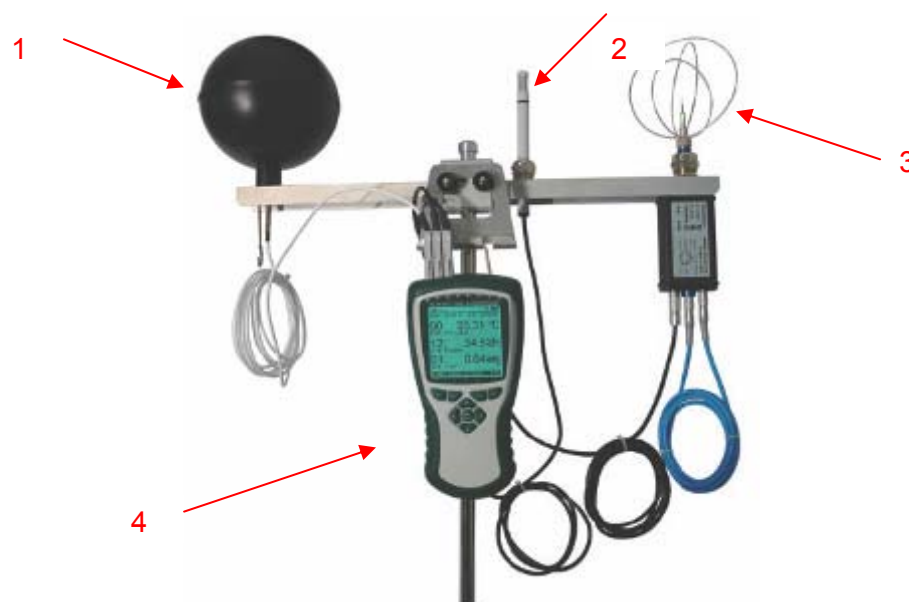
Abb. 75 Aufbau einer Behaglichkeitsmessstation:
