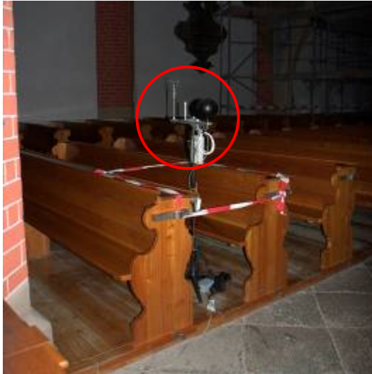
Abb. 74 Behaglichkeitsmessung im Bereich der Bankreihen
