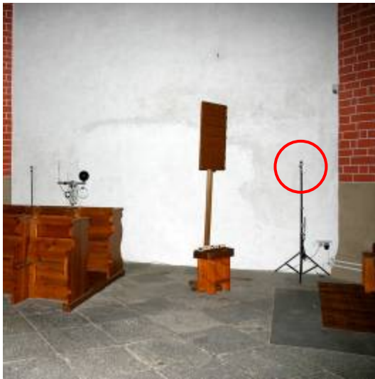
Abb. 78 Messpunkt der CO 2 – Konzentration der Raumluft
