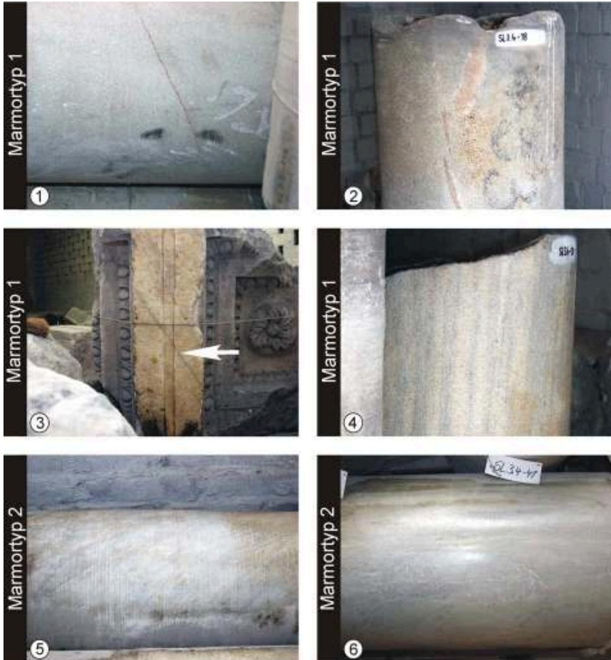
Abb. 1: Ausgebohrter Säulen kern des vorwiegend undifferenzierten Marmors mit mineralisiertem Riss.
