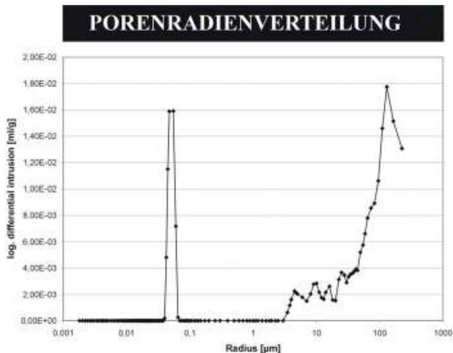
**Abb. 7.2:** Porenradienverteilung des Marmors aus Bohrkern I.
