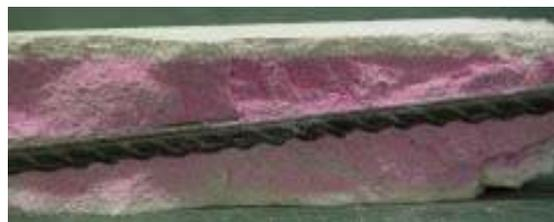
Abb.16: Phenolphthaleintest der Probe M 4.20
