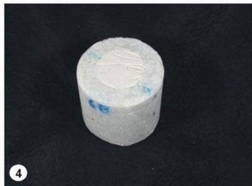
**Abb. 1:** schnelle Aushärtung im Marmor 32 mit anschließender Tränkung in Acrylharz.
