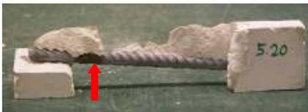
Abb.15: Korrosion am Stahl der Probe M 5.20
