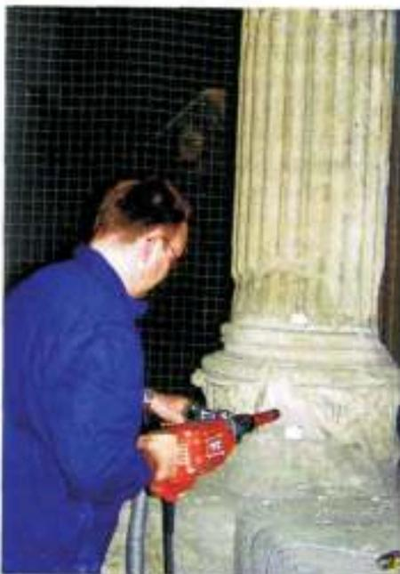
Abb. 6: Probenahme zur Analyse der Tiefenverteilung von Salzen und Mörteln.
