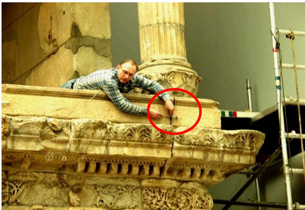
Bild 5: Messaufbau des Wegaufnehmers 1
