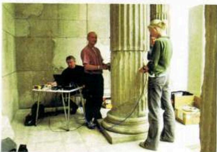
werden können. Rissöffnungen und ihre Vernetzungen belegen, dass Spannungen vom starren »Stahlkorsett« auf das Bauwerk übertragen werden. Diese Bewegungen scheinen nach ersten Erkenntnissen in der Längsrichtung und auch quer dazu aktiv zu sein. Daher ist es ein wesentliches Ziel, die für die Wissenschaft überaus wertvolle Originalsubstanz an antiken Oberflächen und Werksteinmaterialien zu erhalten.
