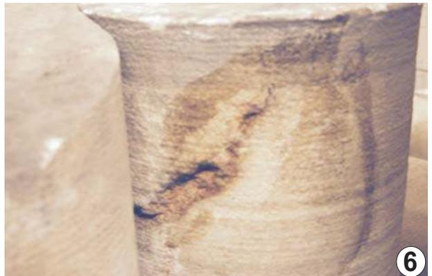
**Abb. 1:** Probe 32 mit deutlicher Foliation, Probenlänge 80 cm.
