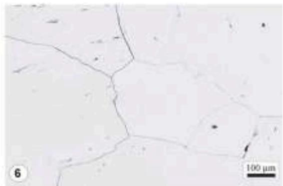
**Abb. 1:** Gering hydraulisches Bindemittel mit CSH-Phasen im Kalkmörtel 2 aus Bohrkern IV; Durchlicht, Bildbreite 0,66 mm.
