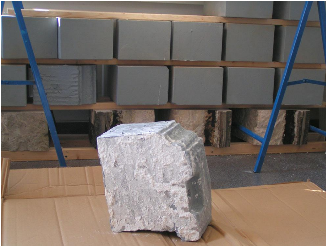
Abbildung 4: Prüfkörper aus Altmaterial nach der Versalzung (getrocknet)
