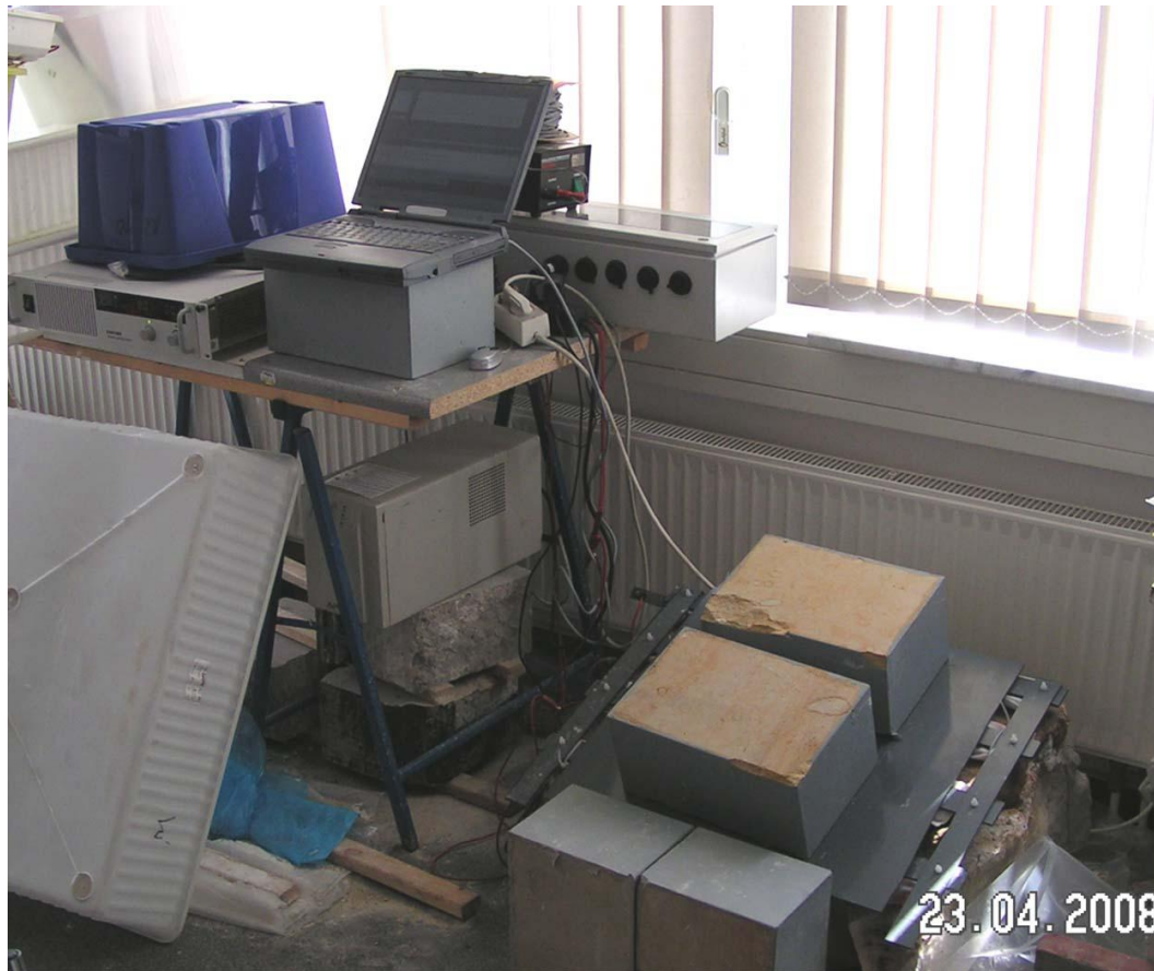
Abbildung 12: Versuchsaufbau zur einseitigen Wandentsalzung/ Prüfkörper horizontal
