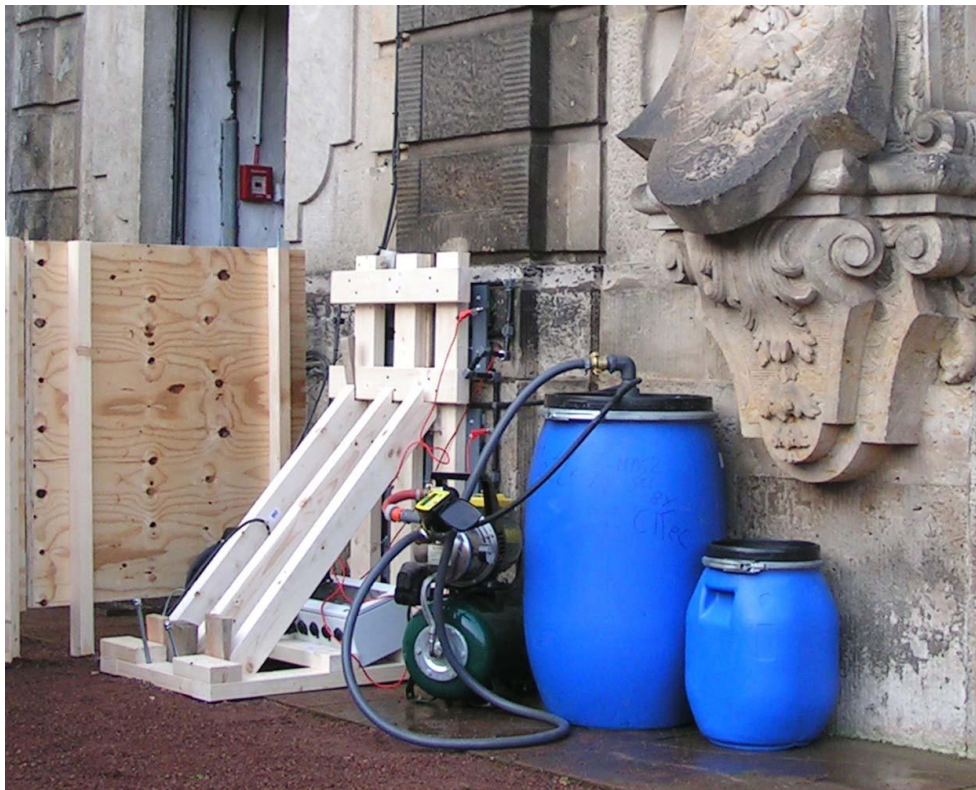
Abbildung 18: Aufbau der Pilotsalzminderung im Dresdner Zwinger
