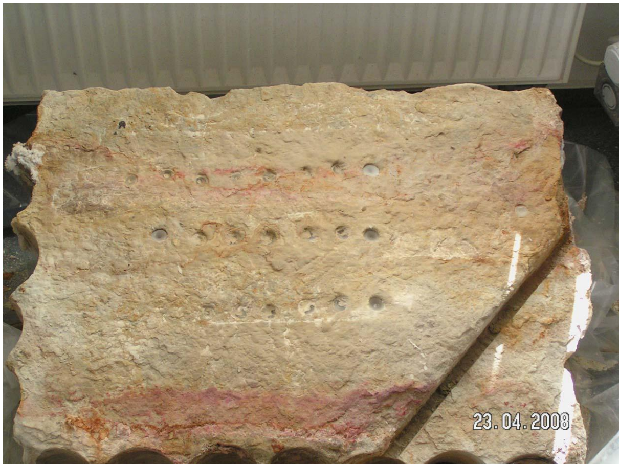
Abbildung 54: Prüfkörper nach der Salzminderung/ horizontale Anordnung
