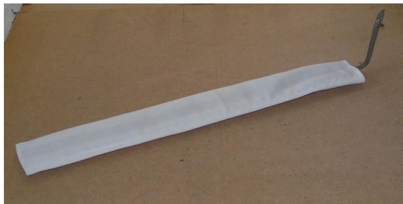
Abbildung 22: Adsorbermatte für Anionen, Ausführung für die einseitige Wandentsalzung
