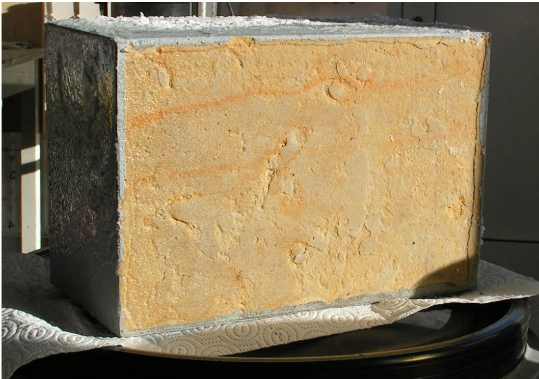
Abbildung 3: Prüfkörper nach der Versalzung (Beginn der Trocknungsphase)
