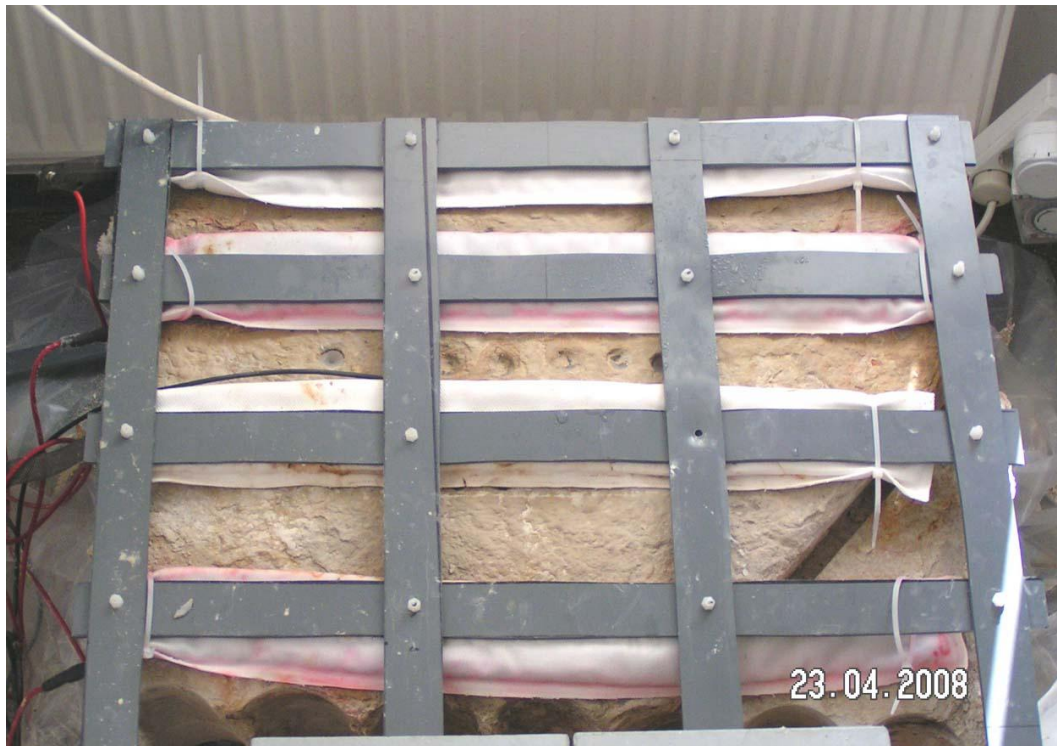
Abbildung 13: Elektrodenanordnung bei der einseitigen Wandentsalzung
