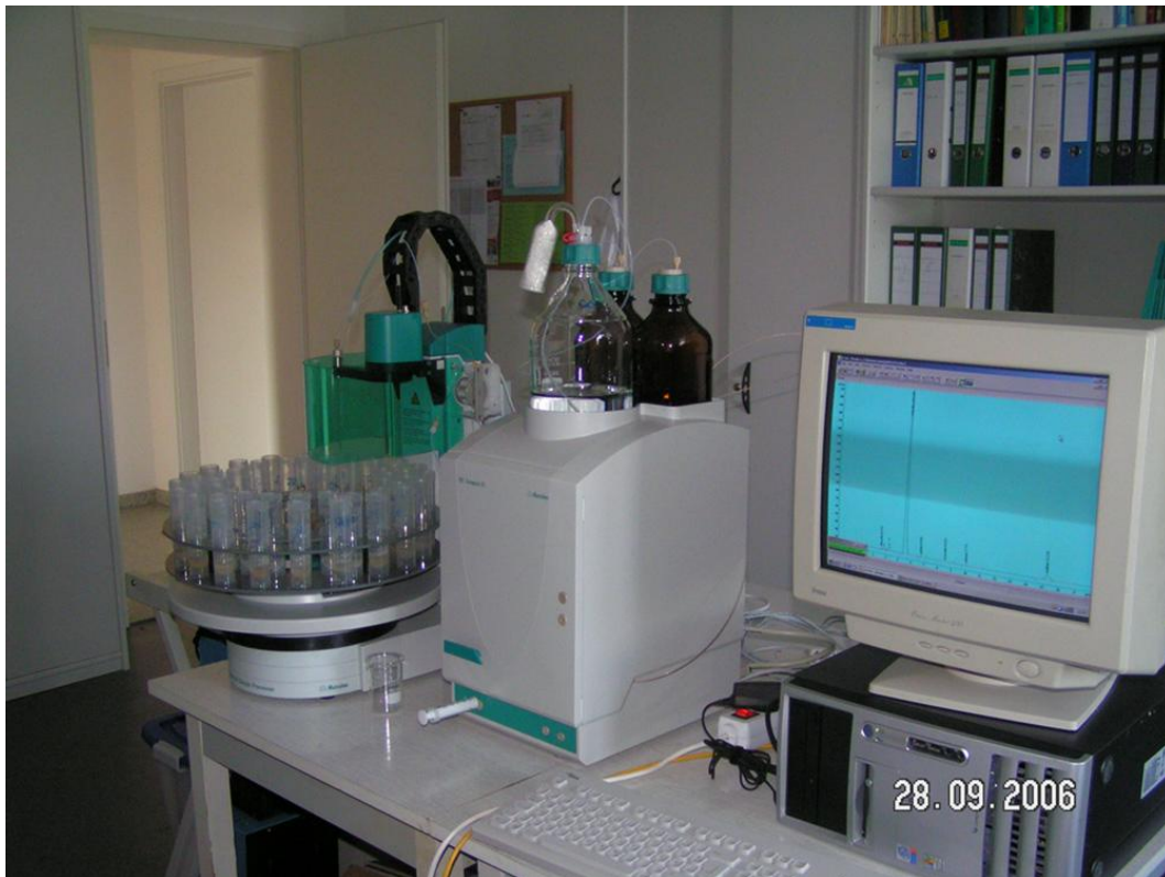
Abbildung 1: Ionenchromatografie zur Bestimmung der steinschädigenden Species
