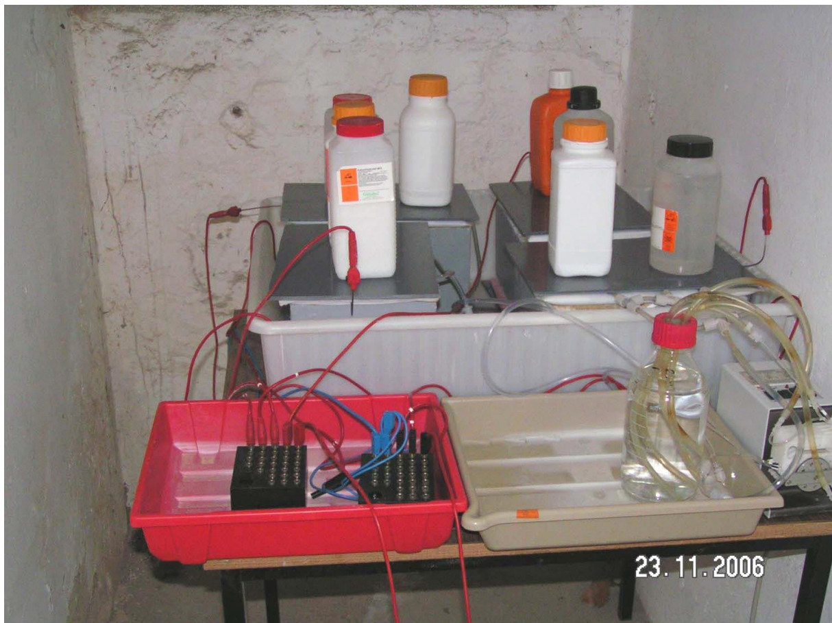
Abbildung 5: Aufbau elektrochemische Salzminderung
