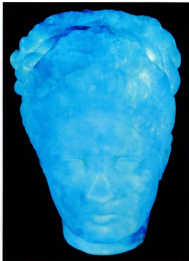
Il. 18. Fotografia głowy w świetle UV, widoczny zakres przesycenia mikrostruktury kamienia masą woskowo-żywiczną. Stan obiektu po oczyszczeniu
